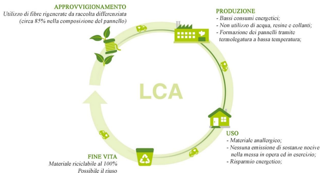
Figura 1 – Schema del ciclo vita di un pannello in fibra di poliestere riciclato
