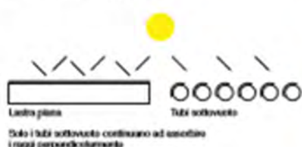
Fig. 476 Caratteristiche fondamentali dei tubi sottovuoto
