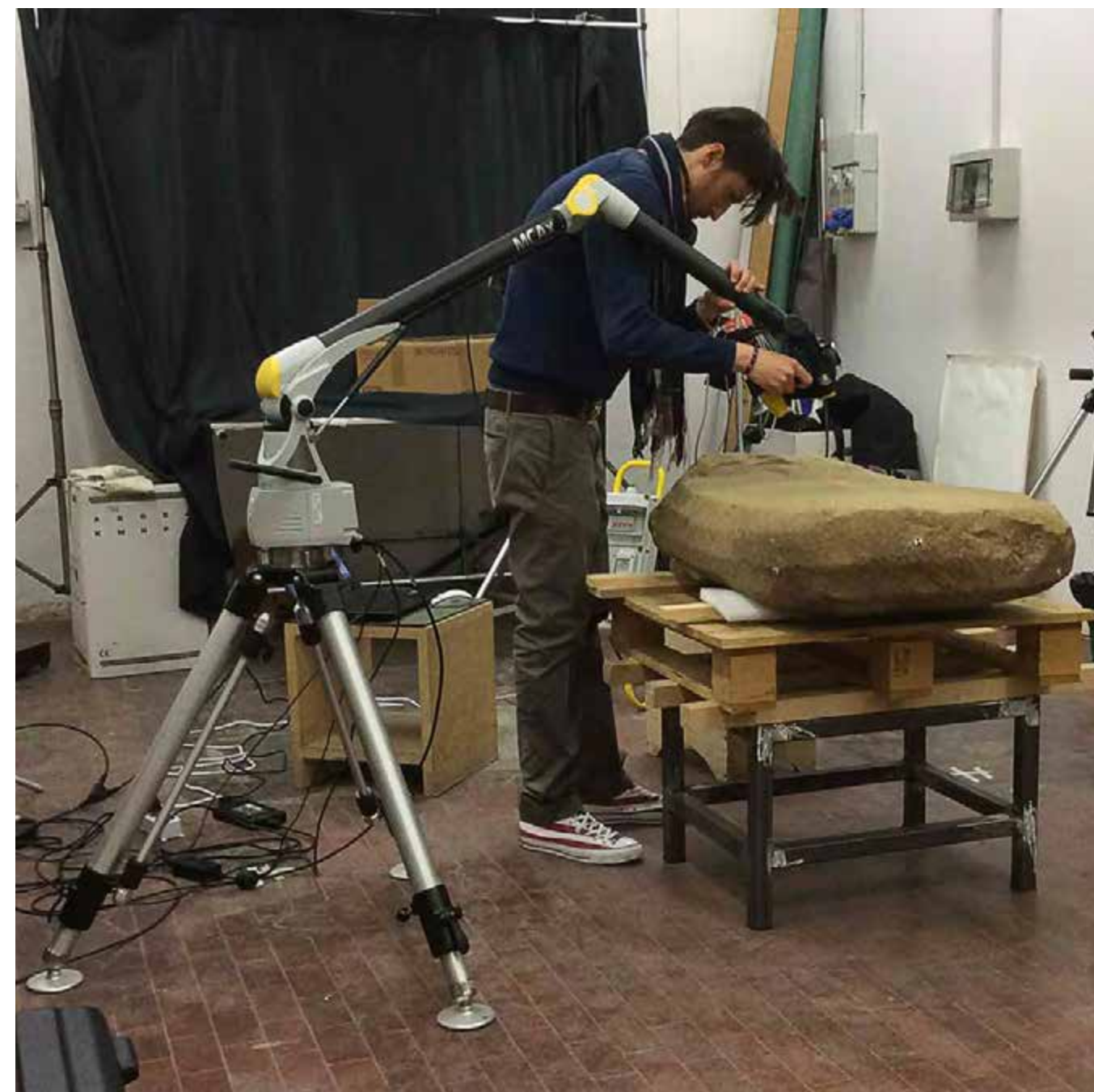
Fig. 33 – Foto scattata durante la fase di acquisizione dati con strumento laser a triangolazione per il rilievo 3D della Stele di Vicchio, eseguito una volta che questa è stata restaurata.
