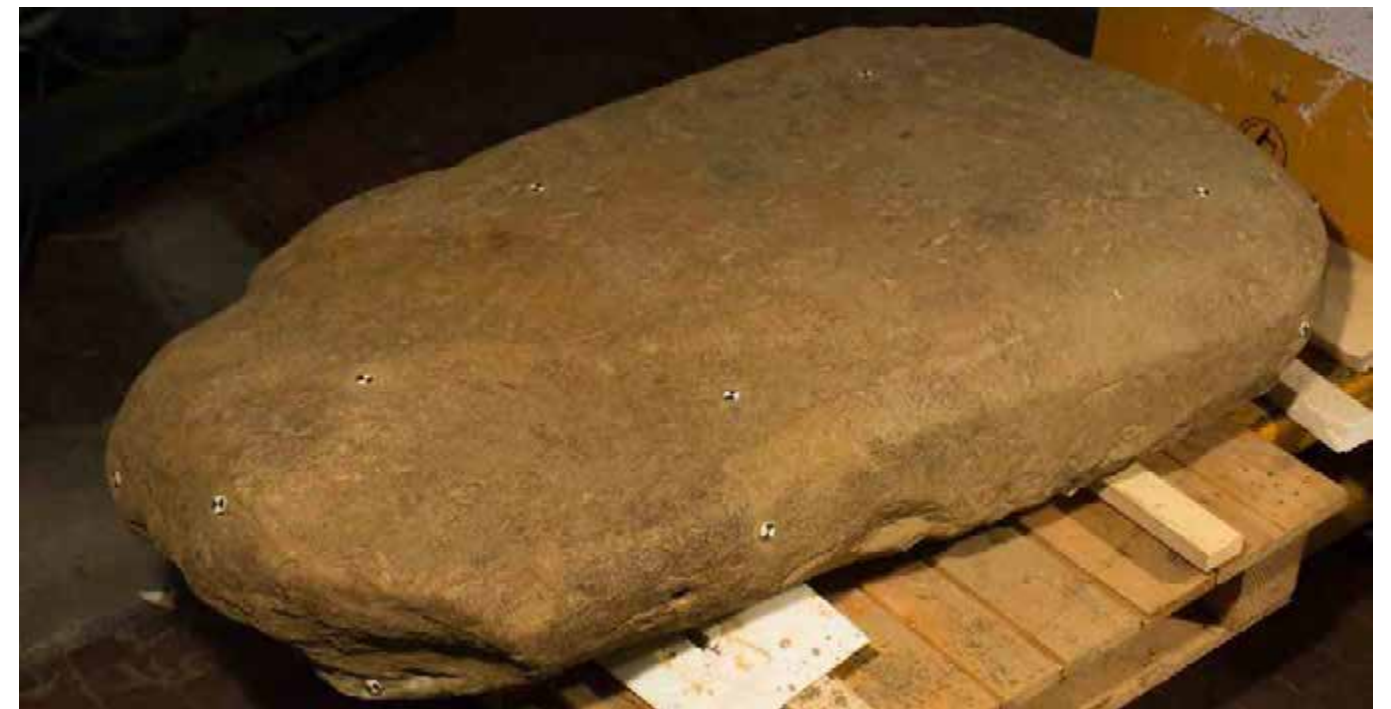
Fig. 78 – (sotto) Foto della Stele. Sulla sua superficie sono ben visibili i targets circolari, posizionati per eseguire il rilievo strumentale e fissati con colla removibile ad acqua.
