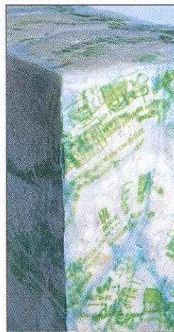
Particolare del blocco in cui si osservano le celle di trucioli sigillate, di forma variabile, ottenute nella pressatura.
