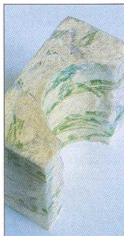
Prototipo per la realizzazione di un imballaggio di oggetto a forma cilindrica.
