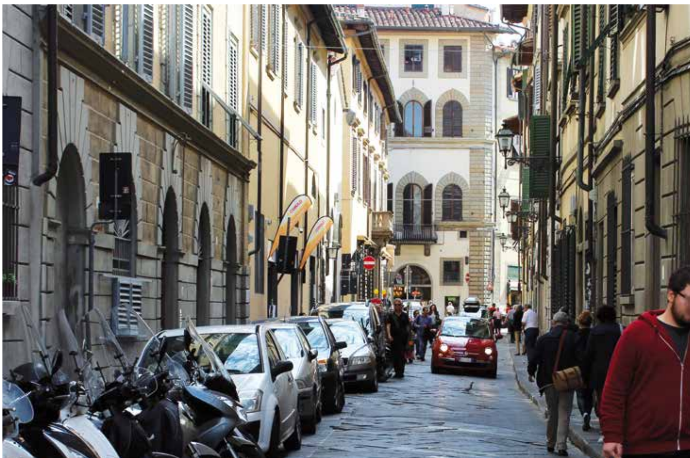
Fig. 3, Nelle vie a sezione limitata, la presenza dei marciapiedi stretti ed invasi dalle auto in sosta costringe i pedoni ad avventurarsi sulla carreggiata costituendo fonte di pericolo
