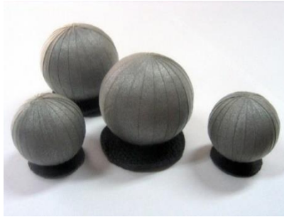
Figura 2.8 – Marker passivi a riconoscimento di soglia
