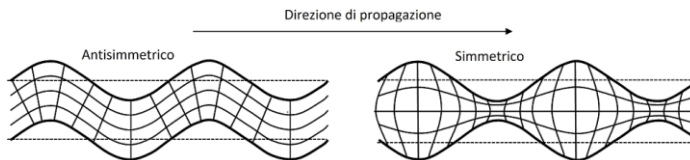
Figura 1: Spostamento dei modi dell’onda di Lamb. A_x modo antisimmetrico, S_x modo simmetrico ( x=0,1,2,\dots ).
