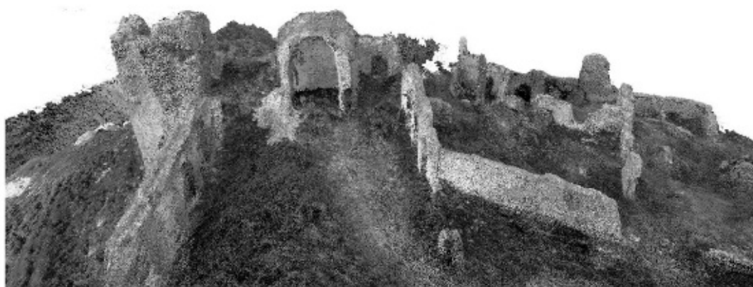
Figura 4. Vista prospettica della nuvola di punti importata nel software Leica Cyclone .
