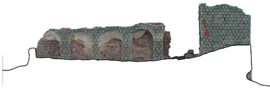
Figura 8. Restituzione grafica dell'analisi del degrado relativa al prospetto laterale interno della chiesa.
