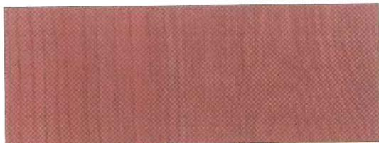
Legno-tessuto prodotto con tranciato di ciliegio di sezione tangenziale (venatura "fiammata"), tinto di colore rosso. Si possono osservare le microincisioni laser a disegni quadrati inclinati a 45° rispetto alla fibratura.
