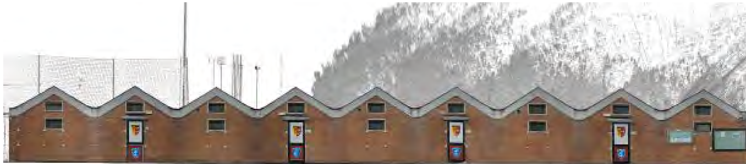
Attraverso il fotorelevamento, applicato alla elaborazione del rilievo integrato mediante laser scanner, sono state eseguite le sezioni e i prospetti delle maggiori strutture edilizie presenti nell'impianto quali gli spogliatoi.
