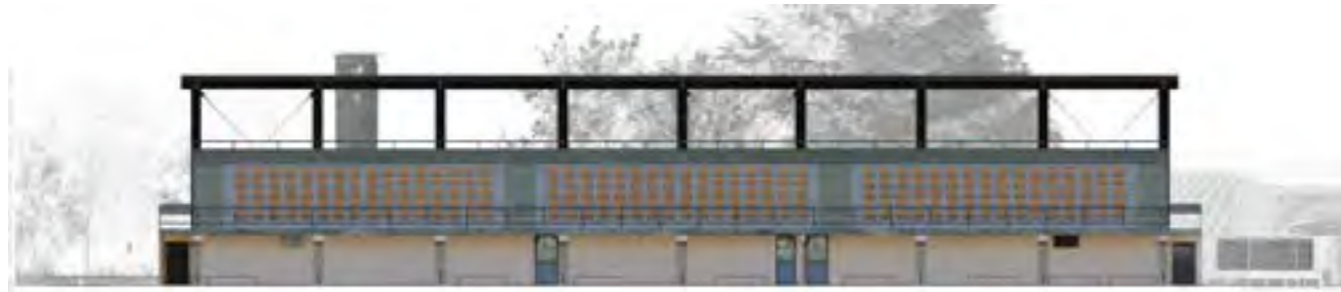
Prospetto della tribuna coperta del campo sportivo, sotto la gradinata sono stati ubicati gli uffici e i magazzini. Sotto è rappresentata la sezione della tribuna.
