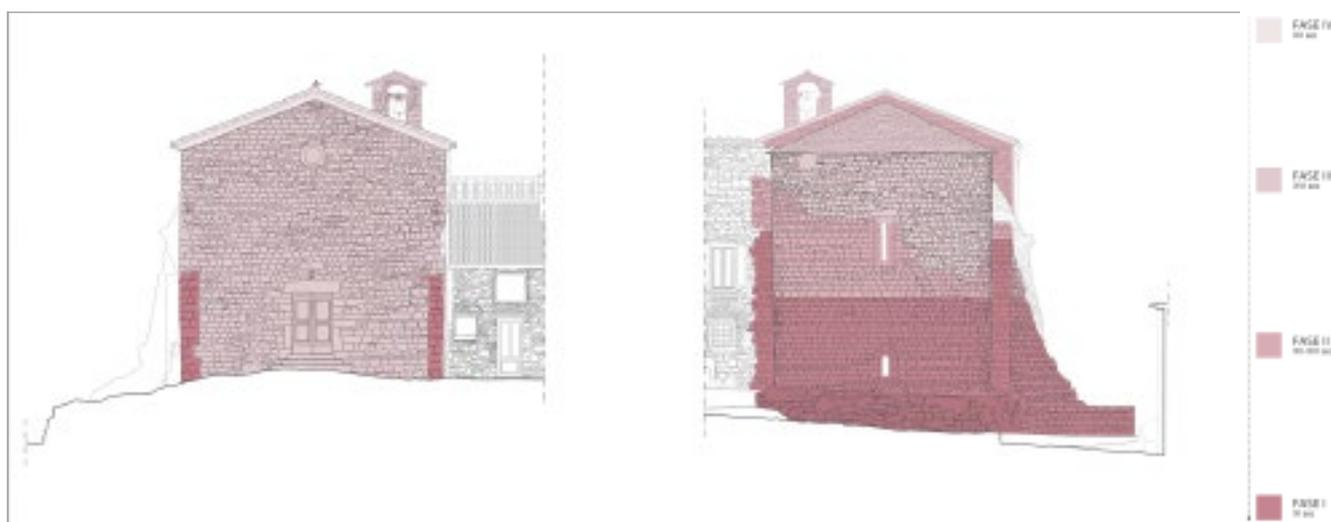
fig. 12 – Fasi costruttive dei prospetti Ovest ed Est.
