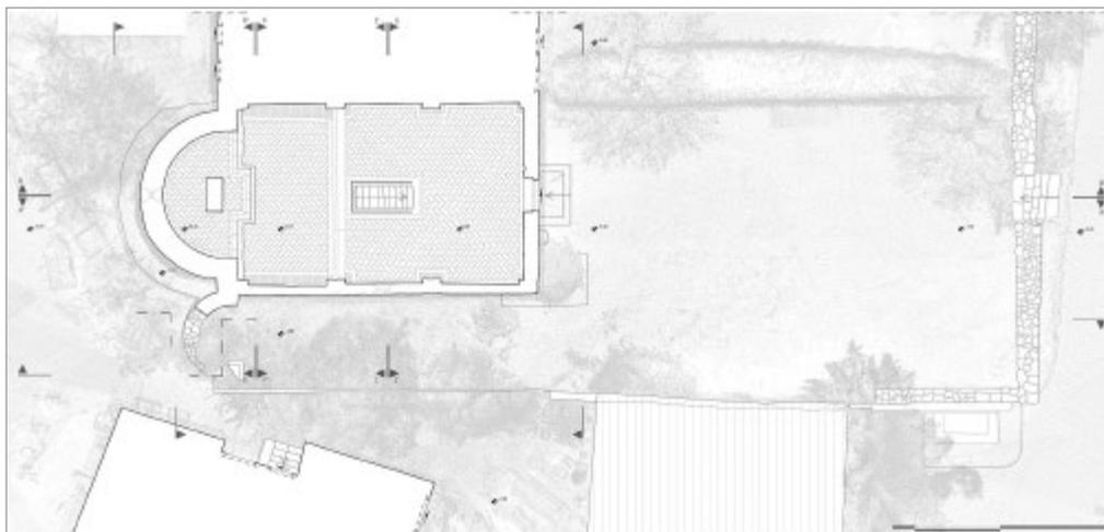
fig. 2 – Planimetria del piano terra della pieve di Santa Maria a Buiano ottenuta dalla digitalizzazione del rilievo laser scanner.
