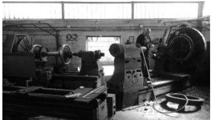
Figura 2 - A sinistra: officina con macchine utensili tradizionali per lavorazioni completamente manuali su sale cerchiato (foto dell’autore, Italia, 2018).
