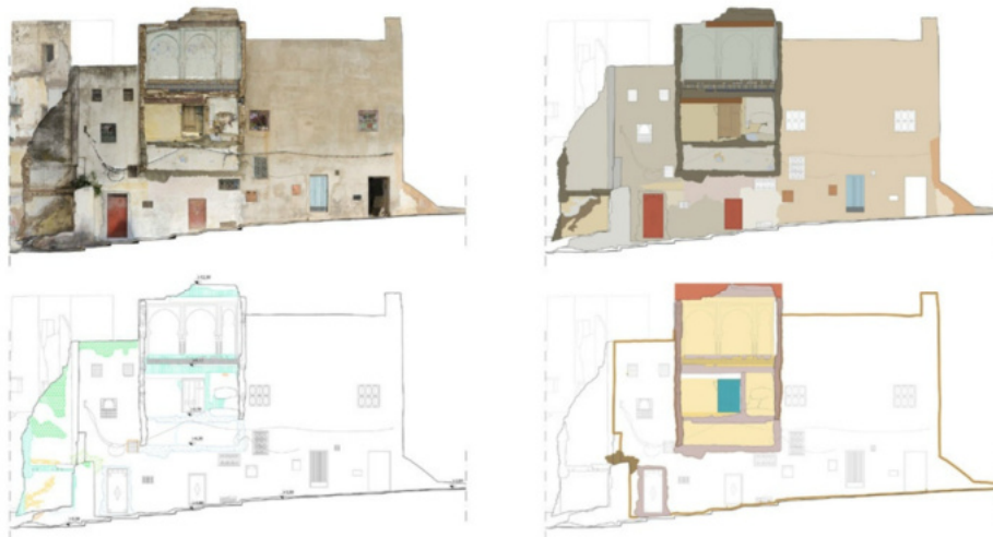
Figura 10. Lettura del degrado e dei materiali in alcune sezioni
