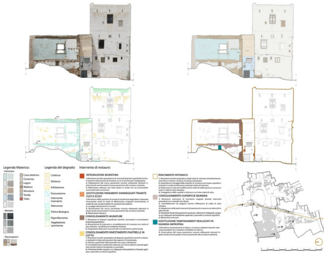
Figura 10. Lettura del degrado e dei materiali in alcune sezioni
