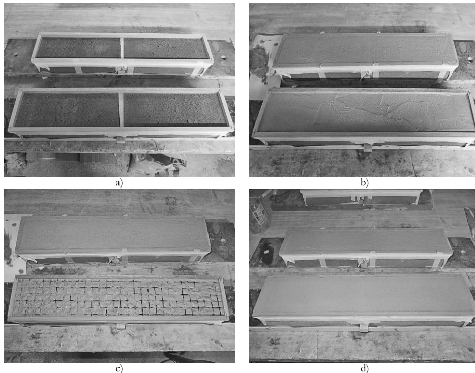
Fig. 5.64. Preparazione dei provini
