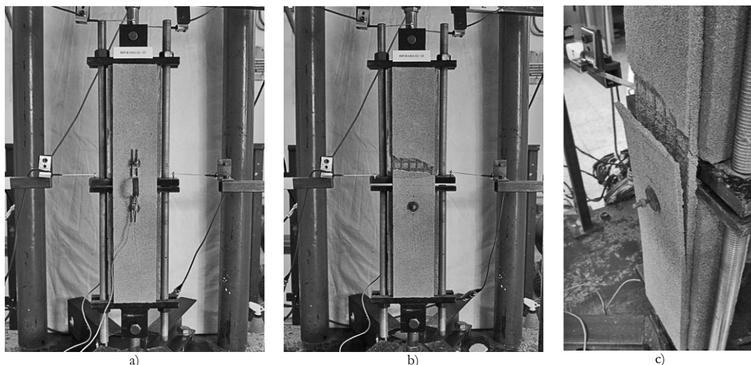
Fig. 5.61. Provino DST-B.MBA.GS-02: a) inizio prova; b) pattern fessurativo; c) propagazione lesione interlaminare
