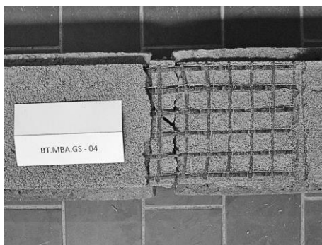
Fig. 5.75. Provino BT.MBA.GS-04: particolare della rete di fibra a prova ultimata
