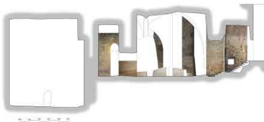
Figura 5 - Rilievo: sezione della Chiesa di Sant'Andrea.; Survey: section of Saint Andrew's church
