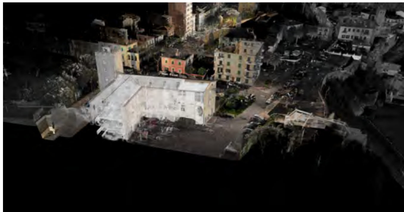
Fig. 17 Vista in proiezione prospettica della nuvola di punti, integrata in parte di dato RGB, della cittadella sezionata per permettere di vedere lo sviluppo interno del Museo Archeologico e le altezze del terreno circostante.
