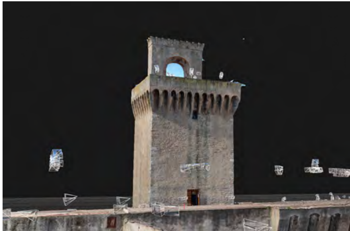
Fig. 19 Vista in proiezione prospettica del modello tridimensionale mappato fotograficamente della torre della Porta di Terra, attraverso ricostruzione S.f.M.; i rettangoli proiettati attorno al modello rappresentano le fotografie allineate per costruire il modello.
