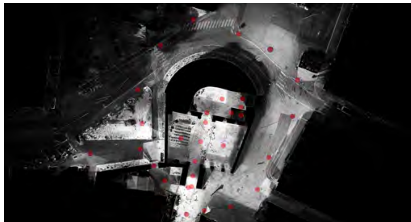
Fig. 12 Vista in proiezione prospettica della nuvola di punti dell rivellino di Rinaldo Orsini, con la porta medievale che si eleva al centro
