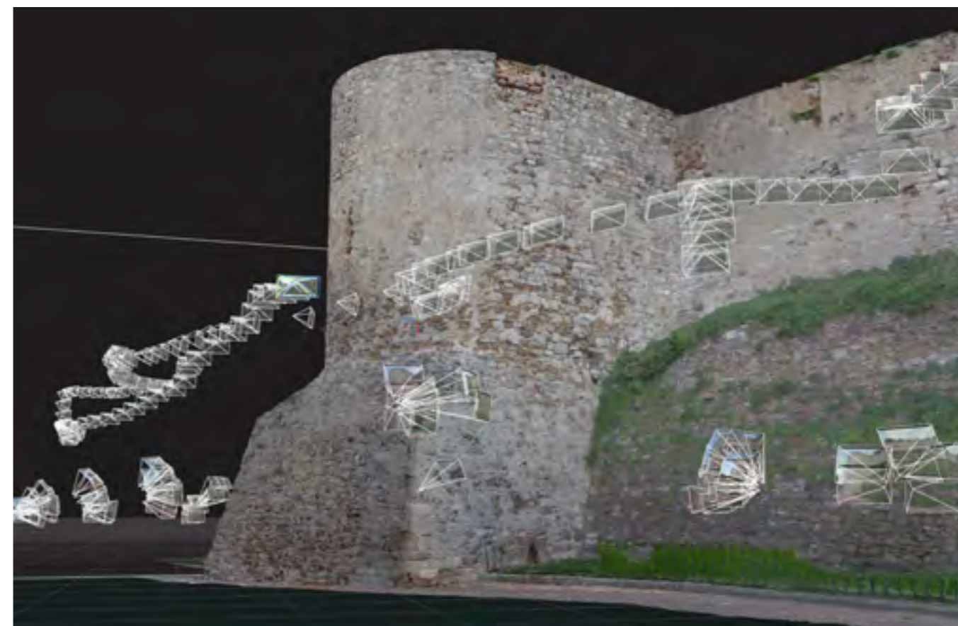
Fig. 25 Dettaglio della superficie mesh con texture applicata di una torre della cittadella: grazie alla realizzazione di un modello geometricamente corretto, come visto nella figura precedente, allo stesso modo la texture delle murature è stata ricostruita in maniera affidabile
