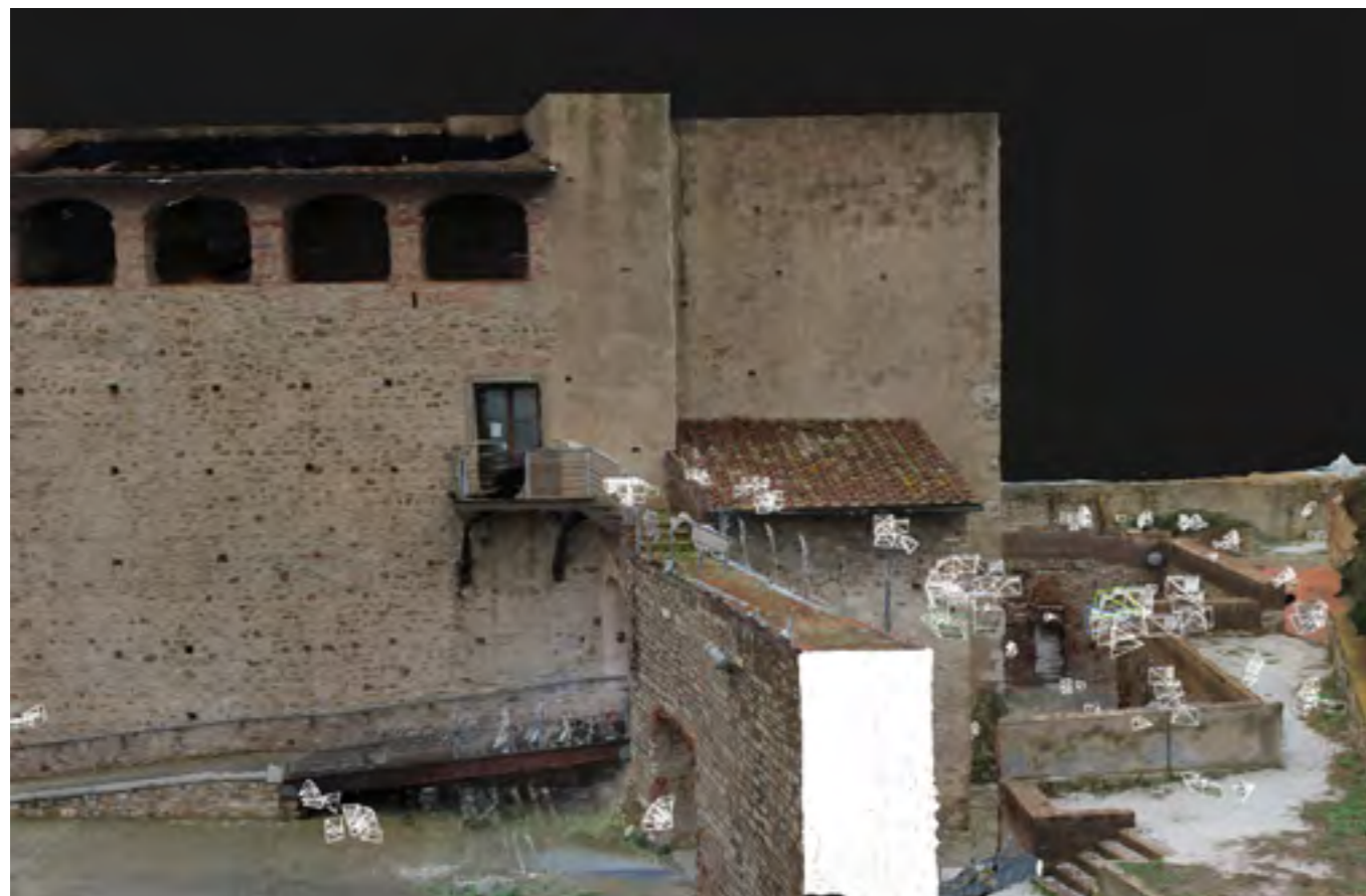
Fig. 21 Vista in proiezione prospettica del modello tridimensionale mappato fotograficamente del Castello di Piombino: si vede la cortina muraria del circuito medievale che si andava ad innestare al Cassero Pisano, prima che le sue dimensioni venissero modificate e racchiuse all'interno della fortezza
