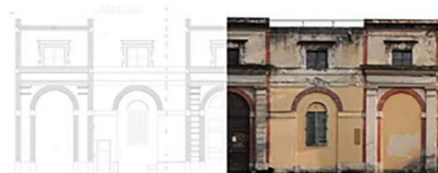
Fig. 8: Planimetrie del Velodromo delle Cascine di Firenze e Sferisterio, elaborazioni ottenute dalla nuvola dei punti
