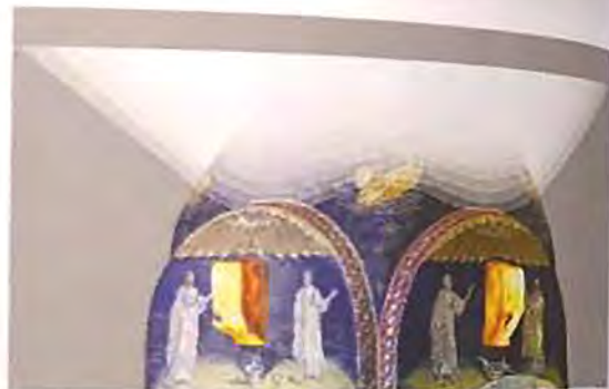
Figura 6. La proiezione ortogonale estratta dal modello mesh testurizzato acquisito tramite processo di foto-modellazione. Le stelle non appartengono a piani paralleli, ma presentano un andamento "festonato". Queste curve sono generate dall'intersezione tra i coni e la superficie della cupola (S. Giannetti).
