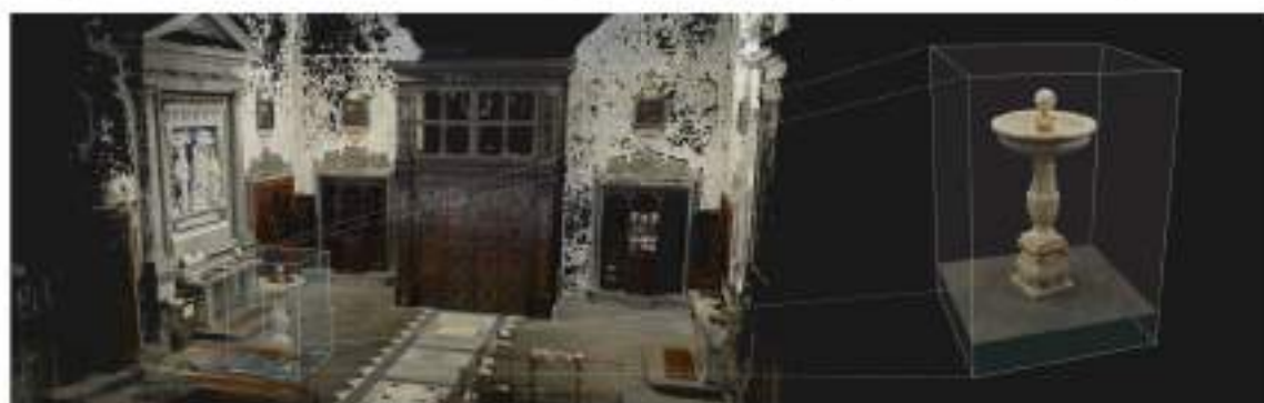
Figura 7. Modelli 3D mappati elaborati dal rilievo fotogrammetrico
