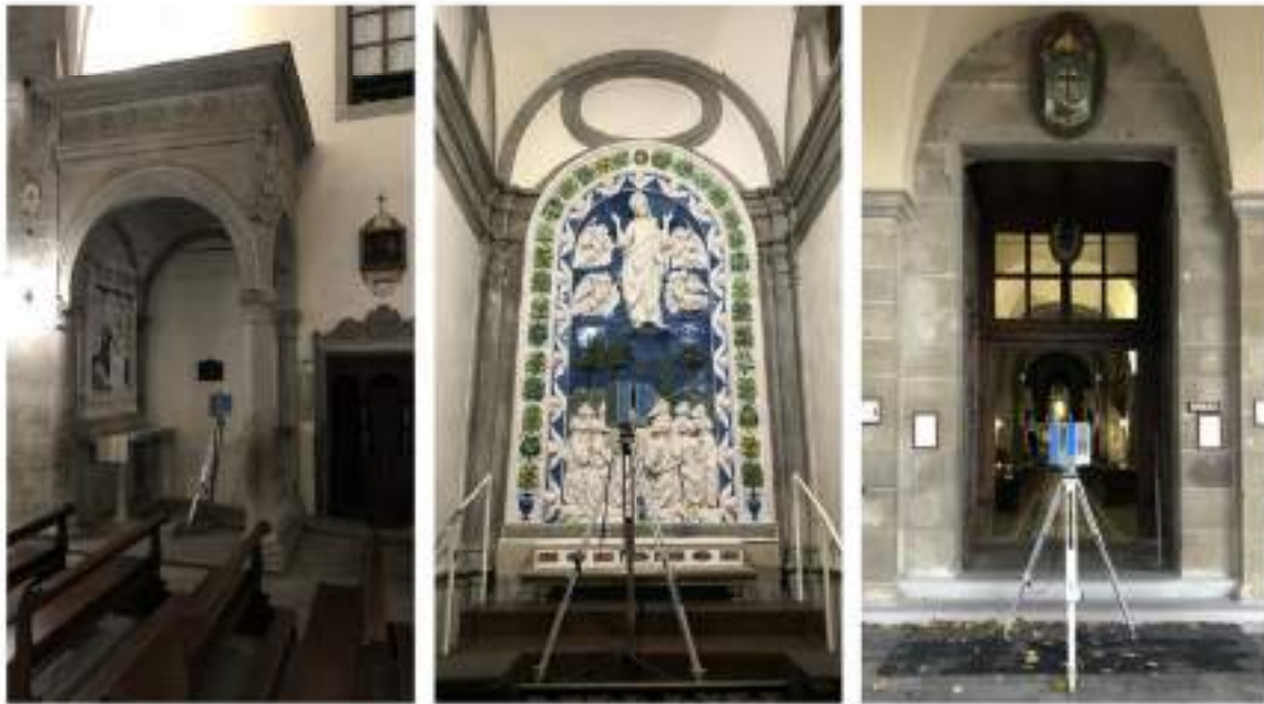
Figura 5. Metodologia di acquisizione dati mediante tecnologia laser-scanner
