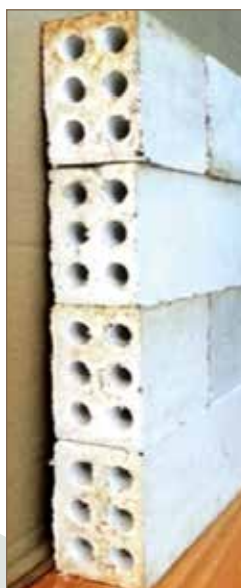
Blocchi sperimentali di particelle di legno e gomma, unite con gesso, per pareti per interni per taglio acustico.
