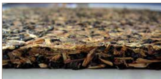
Pannello composito legno-gomma, di apparenza simile a un pannello di particelle.
