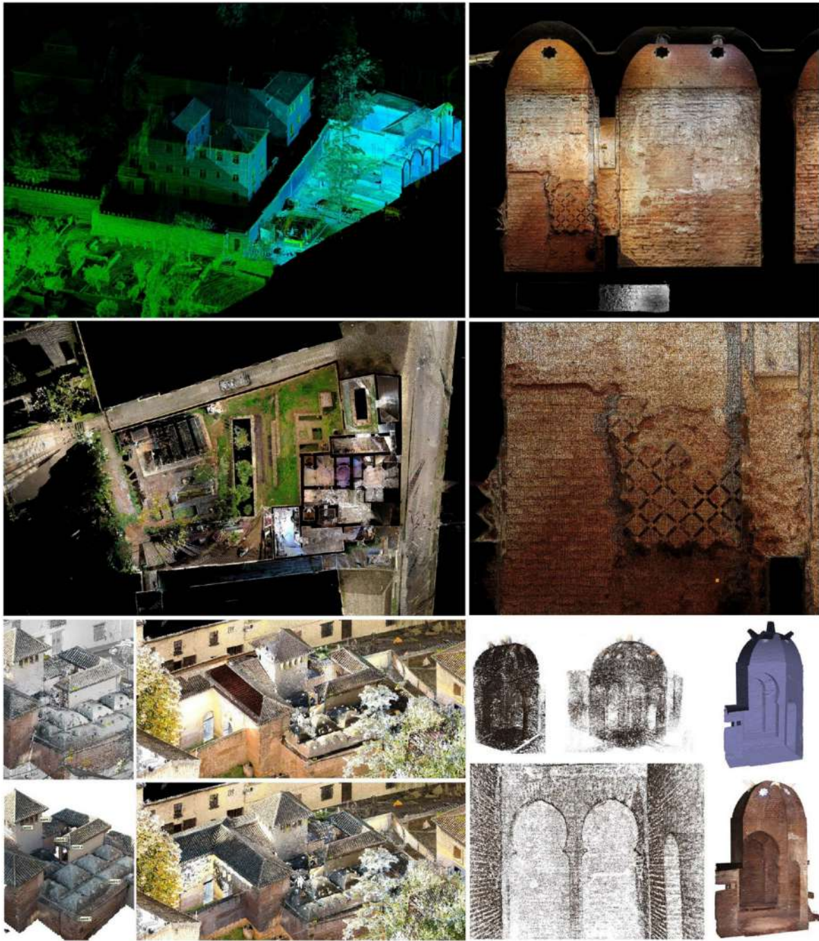
Figura 8. Il rilievo dei Bagni dell'Alhambra alcune immagini dell'output della nuvola di punti, l'integrazione del dato della nuvola di punti con il dato elaborato dal rilievo fotogrammetrico.
