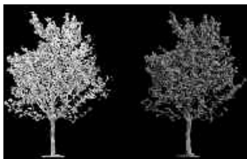
7. Modello 3D di un albero: a sinistra la points cloud ed a destra il modello poligonale (© Cultural Heritage Management Lab - DIDA Unifi).
