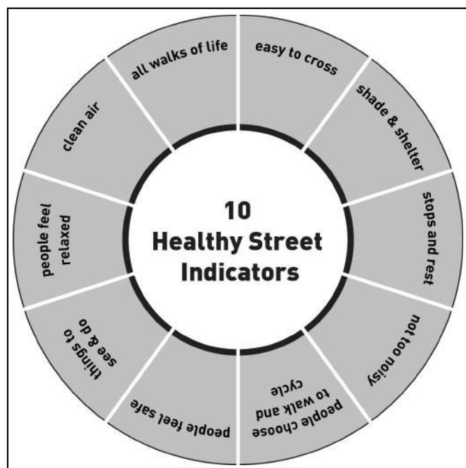
Figura 13 - I dieci Healthy Street Indicators indicano alcune delle più importanti proprietà ambientali dello spazio urbano che influiscono maggiormente sulla salute pubblica (ridisegnato da Transport for London , 2017).
