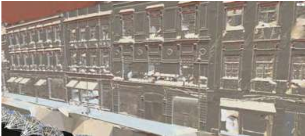
Fig.107 Immagine del modello mesh dell'isolato dove è possibile comprendere la qualità morfologica della maglia di triangoli che riesce a definire accuratamente il dettaglio architettonico delle facciate
