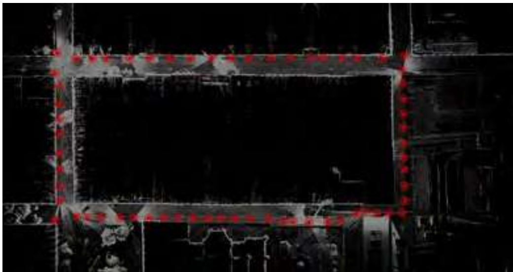
Fig.95 Immagine zenitale dalla nuvola di punti laser scanner con individuazione dei punti di stazione da cui sono state realizzate le scansioni.
