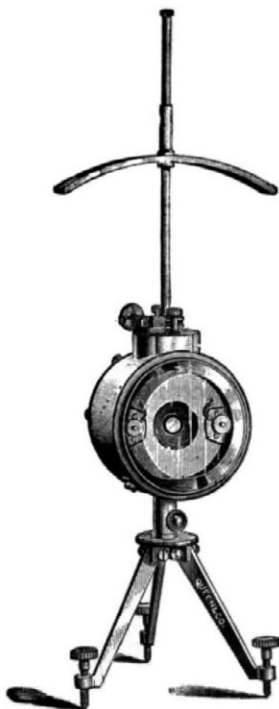
Figura 3. Galvanometro a specchio di Thomson, circa 1900. Da https://en.wikipedia.org/wiki/Mirror_galvanometer .
