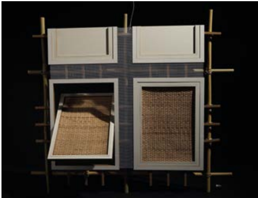
pagina a fronte Infisso con sistema integrato di schermatura solare Modello finale (Carmignani A. Pizzo L., Purcareata A.)
