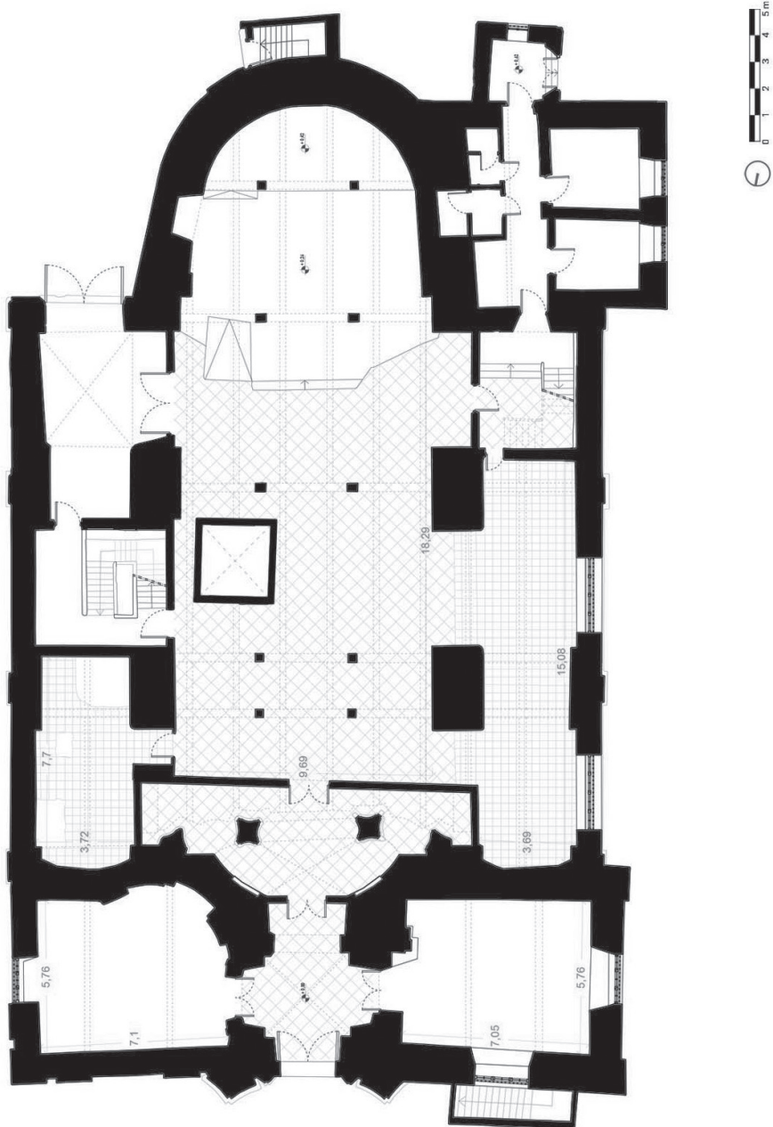
Fig.3: Planimetria del piano terra in cui è chiaramente individuabile la struttura dei pilastri del periodo sovietico.
