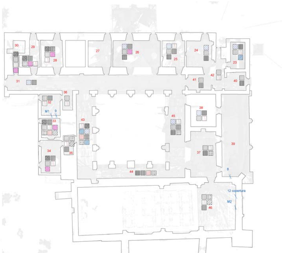
Immagine 89 – Pianta piano terra e primo con rappresentazione per ogni ambiente i principali fattori di degrado secondo Normal 1/88
