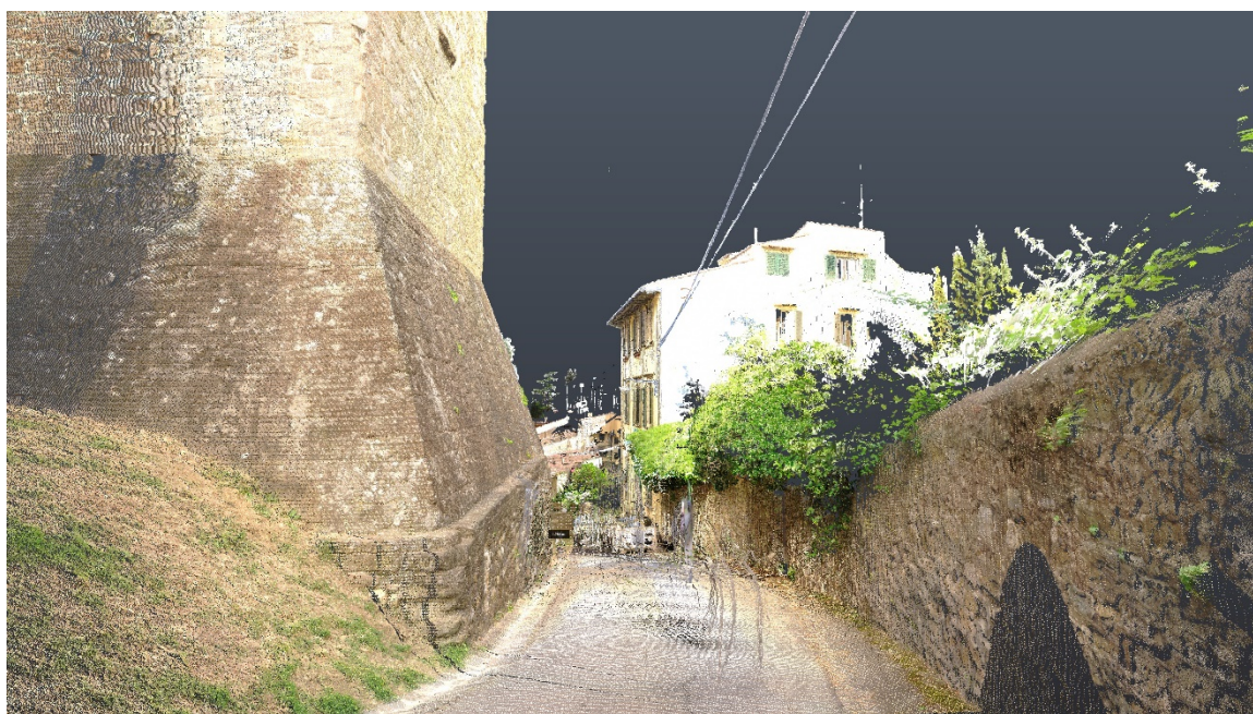
Immagine 24 - Dettaglio nuvola di punti rimontata del tratto in esame
