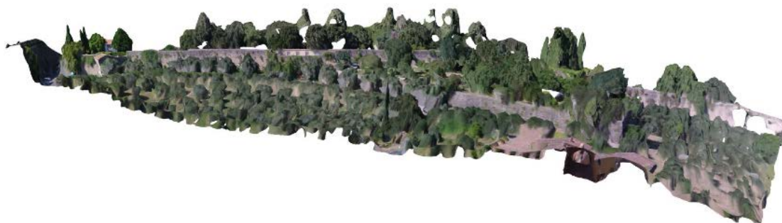
Immagine 18 - Particolari modello 3d ottenuto grazie alla fotogrammetria con drone
