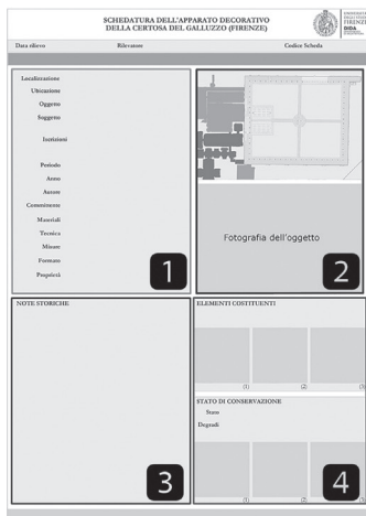
Fig.2: La ricerca ha previsto la strutturazione di un apposito sistema di schedatura degli elementi architettonici e decorativi finalizzati alla realizzazione di un modello tridimensionale informativo. Il censimento, che aggiorna il precedente lavoro svolto dalla Soprintendenza locale, ha riguardato i tondi, le lunette e i capitelli presenti nel Chiostro Grande. La scheda è strutturata in quattro sezioni: 1] Informazioni generali (autore e committente, collocazione, descrizione dell'oggetto); 2] Riferimenti fotografici (inquadramento all'interno del Chiostro Grande, fotografia dell'oggetto studiato); 3] Informazioni storiche (notizie storiche, ricerca d'archivio); 4] Analisi dell'oggetto (elementi costituenti, stato di conservazione e criticità).
