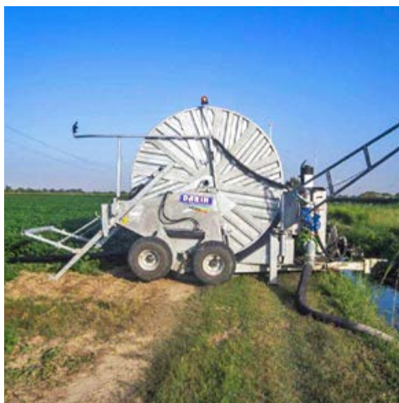
A sinistra, semovente zincato a due assi, tipologia scelta per durata e sicurezza della macchina
