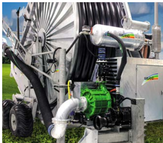
A sinistra, semovente zincato a due assi, tipologia scelta per durata e sicurezza della macchina
