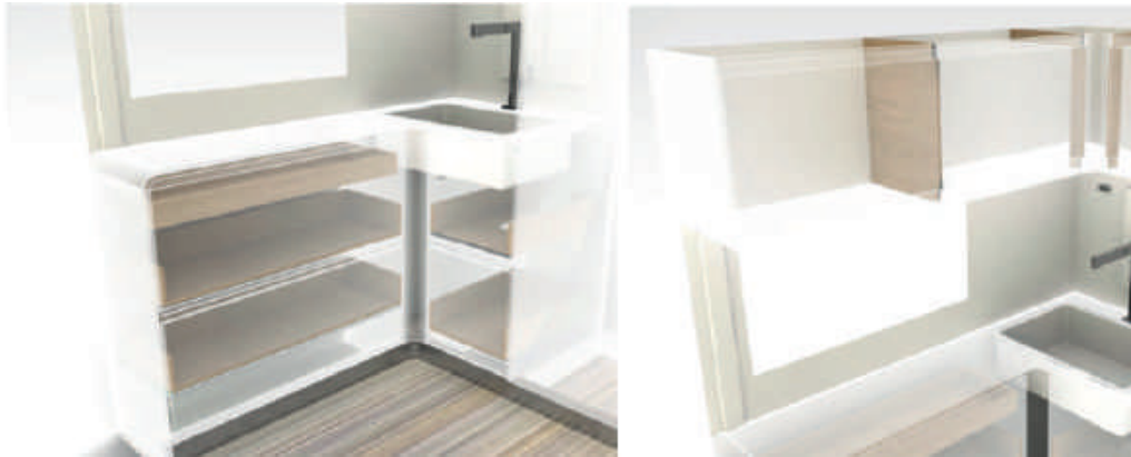
Fig. 12.14 | Sviluppo della struttura interna della cucina.
