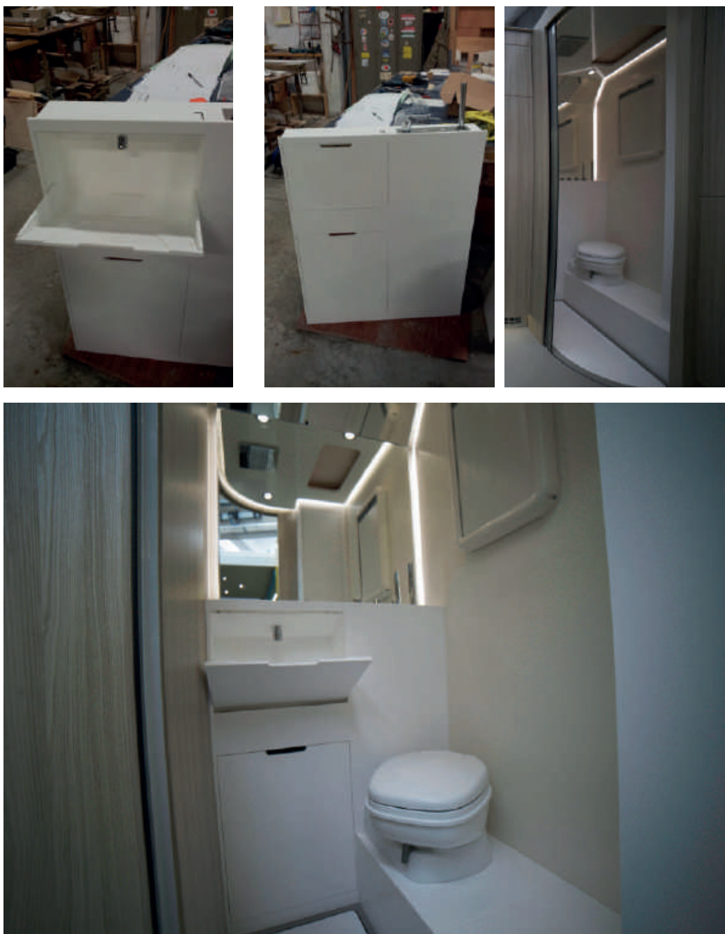
Fig. 12.18 | Concept open space 230 - Sviluppo e realizzazione del sistema toilette e foto del prototipo finale.
