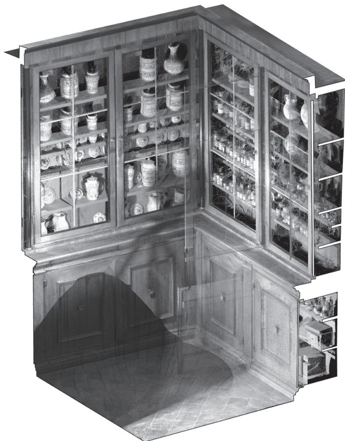
*Fig.2: Spaccato assonometrico della nuvola di punti colorata che mostra l'articolazione del sistema di arredo. Le scansioni sono state effettuate in stazioni sovrapposte a diverse altezze con le ante prima aperte e poi chiuse, finalizzate ad acquisire le suppellettili contenute al suo interno e a limitare la presenza di coni d'ombra. La nuvola di punti ha richiesto un'accurata fase di pulizia per la riduzione del rumore derivata dalle superfici vetrate e dai materiali ceramici.*
