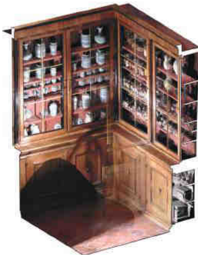
Fig. 31 Spaccato assonometrico della nuvola di punti colorata che mostra l'articolazione del sistema di arredo della farmacia del Santuario della Verna.
