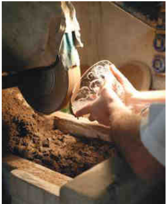
Fig. 3 Molatura del vetro presso la moleria Locchi in Via Domenico Burchiello.
