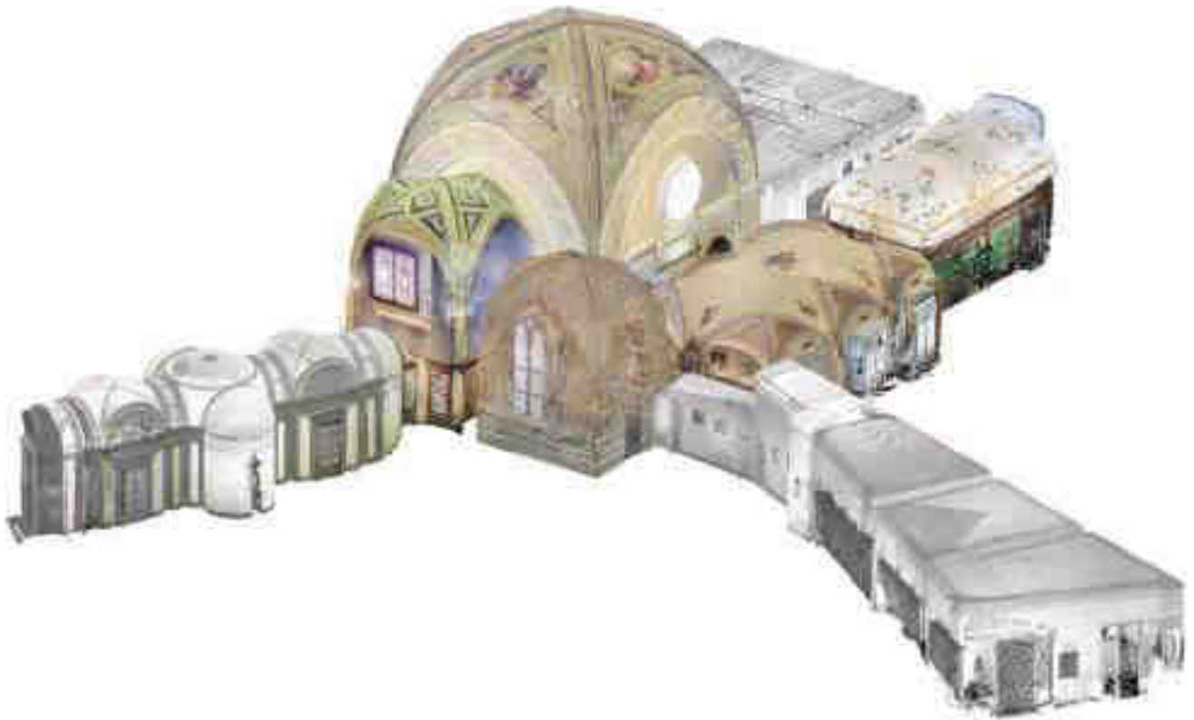
Fig. 32 Vista assonometrica della nuvola di punti colorata del complesso dell'Officina Profumo-Farmaceutica di Santa Maria Novella in via della Scala 16 a Firenze, realizzata con un laser scanner Z+F IMAGER 5016.
