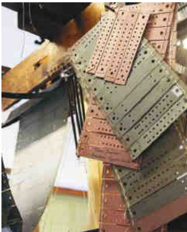
Fig. 5 Matrici per telai per la realizzazione di tessuti e arazzi della Fondazione Arte della Seta Lizio, in via Benedetto Fortini, Firenze (2018). Foto dell'autore.
