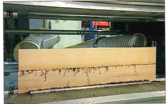
Tavole unite di bordo. Durante il processo un po' di legno fuso viene proiettato fuori dal piano di compressione.
