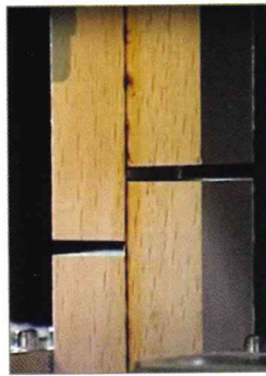
Prove meccaniche di resistenza a taglio per trazione effettuate sulla linea di unione.
