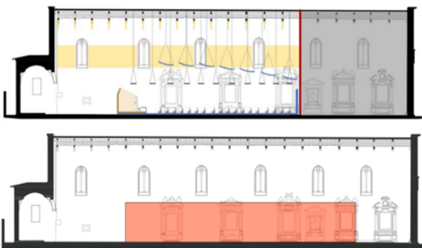
Figura 5 – Confronto tra l'estremizzazione dell'intervento della prima ipotesi (in alto) e il concetto di concentrazione degli interventi in un unico blocco della seconda ipotesi (in basso).
