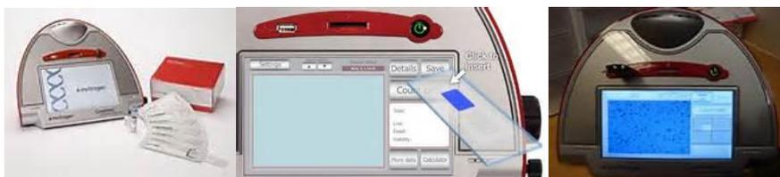
**Figura 34.** Immagine di un contatore COUNTESS™ (Invitrogen™) nel quale si inserisce il vetrino contenente le cellule da contare, colorate con il trypan blu. Lo strumento visualizza le cellule e conta sia quelle vitali che quelle morte, il cui citoplasma risulta colorato di blu.
