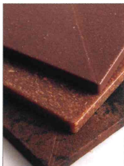
Figura 2 - In base alla formulazione il prodotto (in tal caso tipi di Arboform®) può assomigliare più alla plastica o dare la sensazione di legno (da materials.soa.utexas.edu ).
