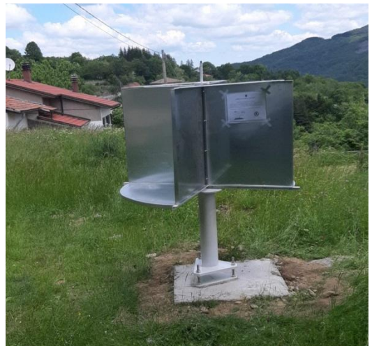
Figura 13 – Riflettore artificiale installato. Fonte: archivio UniFI
