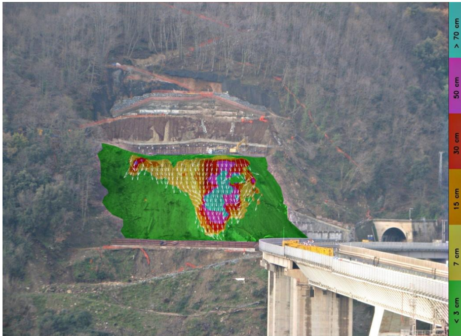
Figura 19 – Esempio di individuazione di aree interessate da spostamenti (freccie e pixel colorati) mediante l'analisi di immagini fotografiche con algoritmi di Digital Image Correlation su versante in frana
