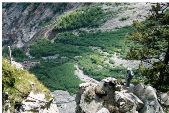
Figura A.1 - Estensimetro a filo area di Sassavin - Valdisotto (SO). Fonte: archivio CMG Arpa Lombardia
