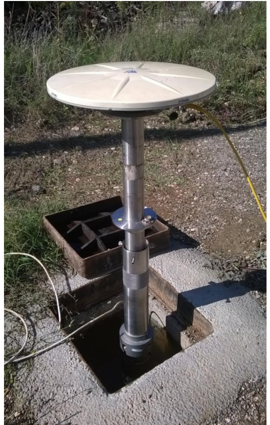
Figura A.14 - Antenna posizionata sulla testa di un inclinometro (Frana di Costa della Gaveta-PZ). Foto da archivio GFI-ISPR
