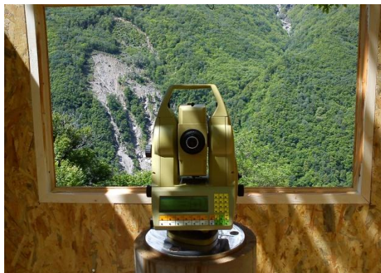
Figura A.8 - Stazione totale per monitoraggio Val Genasca- S. Giacomo Filippo (SO). Fonte: archivio CMG Arpa Lombardia
