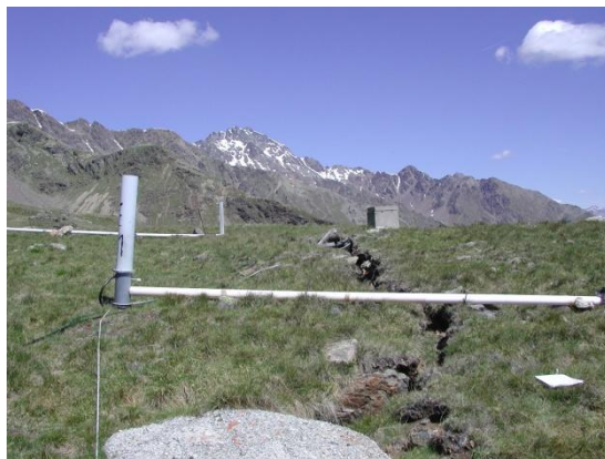
Figura A.2 - Estensimetro a filo protetto da tubo in pvc, vertice frana di Val Pola- Valdisotto (SO). Fonte: archivio CMG Arpa Lombardia
