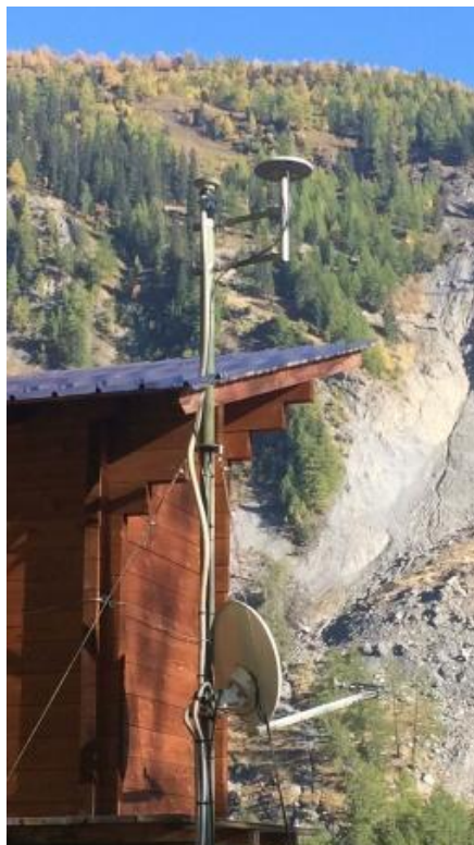
Figura 51 - Esempio di installazione di sistema broadband satellitare (antenna a parabola bidirezionale in basso) per la ridondanza dei dati del sistema di monitoraggio della Frana del Mont de La Saxe (Aosta): Fonte: archivio Attività geologiche – Regione Autonoma Valle d'Aosta
