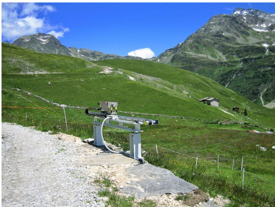
Figura 12 – Monitoraggio periodico con radar interferometrico del versante del Mater in Comune di Madesimo (SO). Fonte: archivio CMG Arpa Lombardia
