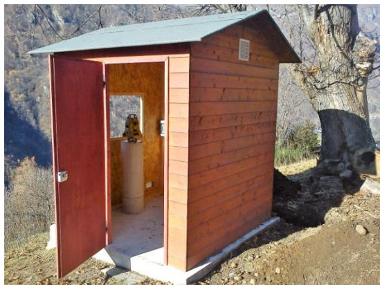
Figura A.10 - Ricovero per monitoraggio topografico in continuo frana di Val Genasca- S. Giacomo Filippo (SO). Fonte: archivio CMG Arpa Lombardia
