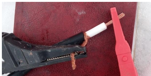
Figura 33 – Collegamento dello strumento al cavo, frana del Monte Mater nel Comune di Madesimo (SO). Fonte: archivio CMG Arpa Lombardia
