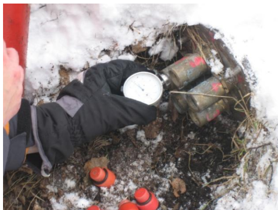
Figura 35 – Estensimetro multibase – versante del monte Leteè (Dorio – LC). Fonte: archivio CMG Arpa Lombardia
