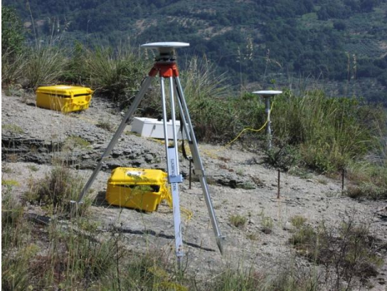
Figura 8 – Monitoraggio in modalità statica con l'utilizzo dei treppiedi (in primo piano) e di un dispositivo con bolla su caposaldo autocentrante (in secondo piano). Fonte: archivio GEO-GFI ISPRA
