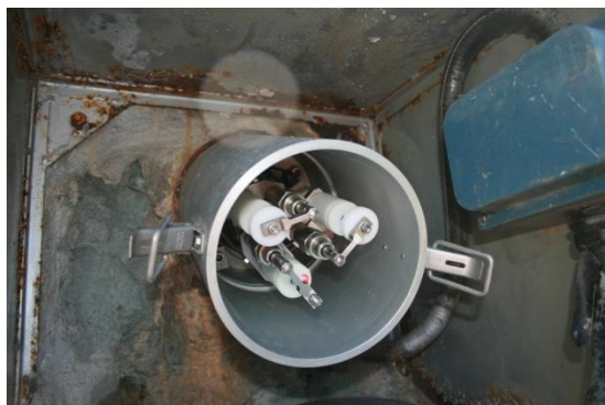
Figura 36 – Estensimetro multibase automatico – loc. Campo Franscia (Lanzada – SO). Fonte: archivio CMG Arpa Lombardia
