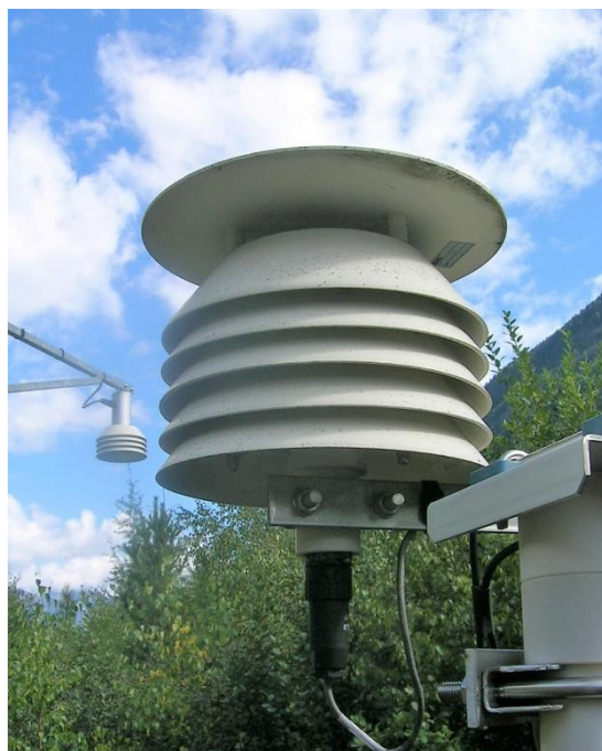
Figura A.48 - Esempio di termometro aria protetto all'interno di capannina antiradiante. Valdisotto (SO). Fonte: archivio CMG Arpa Lombardia
