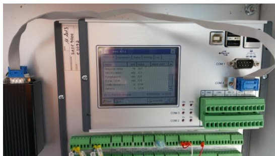
Figura A.50 - Esempio di datalogger con sistema operativo Windows CE, un congruo numero di canali, diverse porte di comunicazione e slot per espansione memoria con SD Card. Fonte: archivio Attività geologiche – Regione Autonoma Valle d'Aosta
