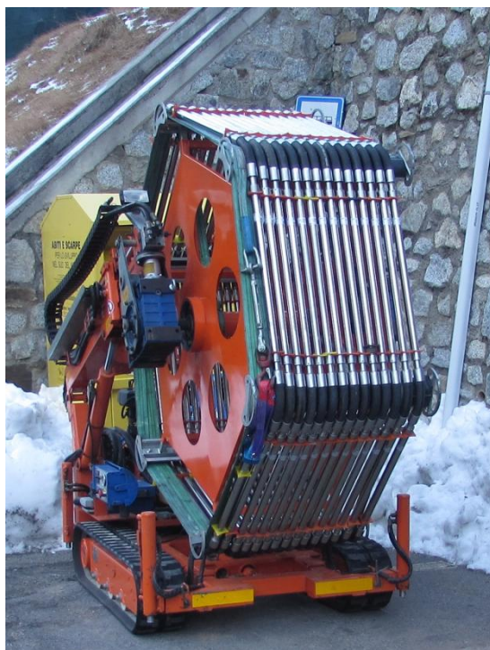
Figura 31 – Esempio di colonna multiparametrica costituita da una catena di sensori montata su un reeler prima dell'installazione (Fonte: archivio CMG Arpa Lombardia)
