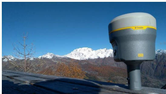
Figura 44 – Esempio di strumentazione di misura (GNSS) installata in campo. Fonte: archivio Attività geologiche – Regione Autonoma Valle d'Aosta
