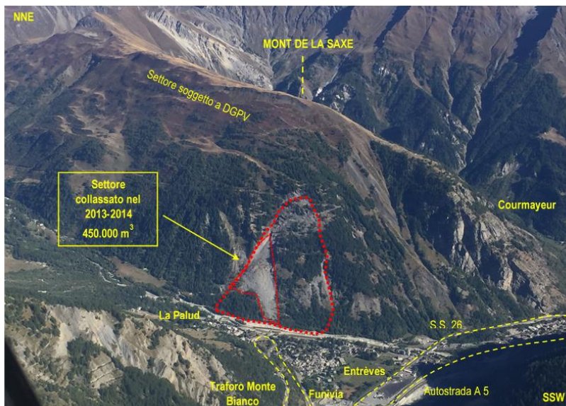
Figura C.3 - Ripresa aerea del versante interessato dalla Frana del Mont de La Saxe (2017) con indicazione dei principali abitati e delle infrastrutture a rischio (Fonte: Regione Aut. Valle d'Aosta - Archivio attività geologiche)
