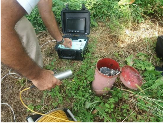
Figura A.31 - Telecamera da foro per l'ispezione del tubo. Fonte: archivio ARPAL
