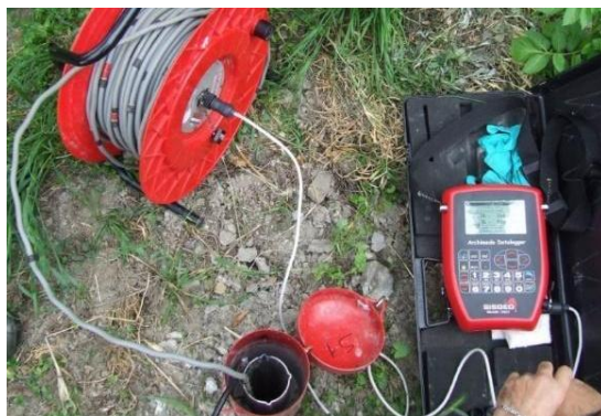
Figura 25 – Datalogger in funzione durante l'acquisizione dei dati inclinometrici. Fonte: archivio ARPAL
