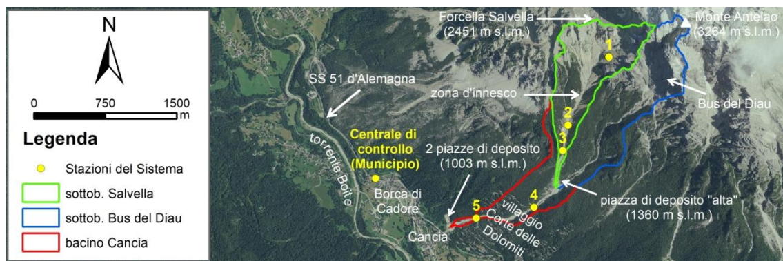
Figura C.16 - Frana di Cancia: inquadramento del dissesto e ubicazione delle stazioni del sistema di monitoraggio e allarme. Fonte: ARPA Veneto
