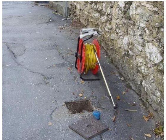
Figura A.32 - Sonda servo-accelerometrica biassiale e cavo da 50 m: ogni sonda con il proprio cavo costituisce un sistema di misura unico non intercambiabile. Fonte: archivio ARPAL
