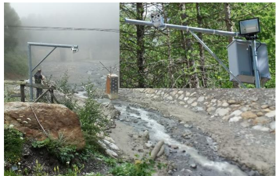
Figura A.26 - Esempio di installazione di webcam e relativo faro (Rio Gadria, BZ). Fonte: CNR IRPI
