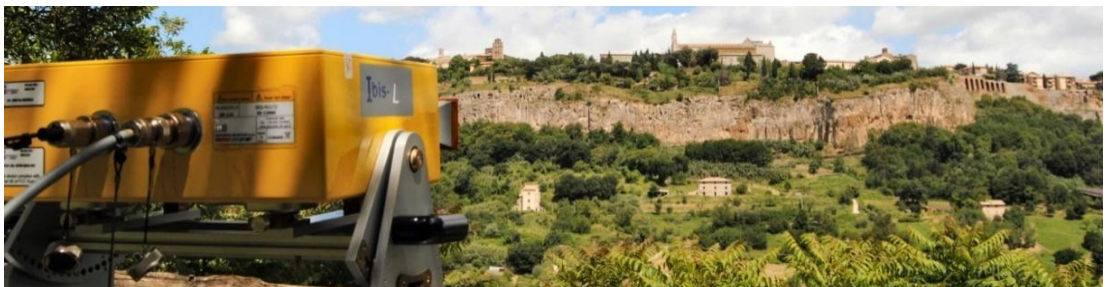
Figura C.19 - Veduta del lato SE della rupe di Orvieto e del pendio argilloso sottostante. In primo piano un radar per misure interferometriche da terra
