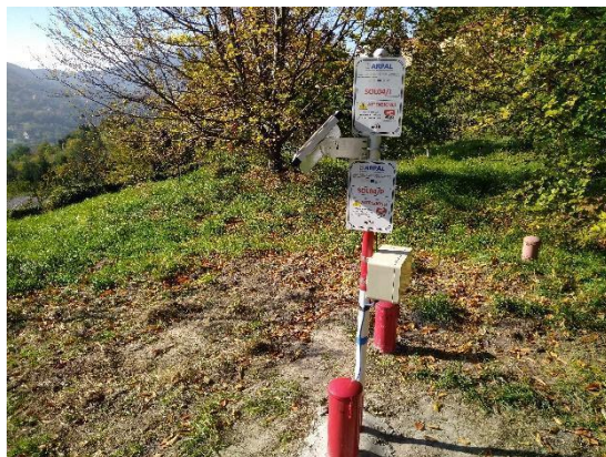
Figura 27 – Pannello solare e datalogger collegato con sonda inclinometrica automatica e piezometro automatico. Fonte: archivio ARPAL
