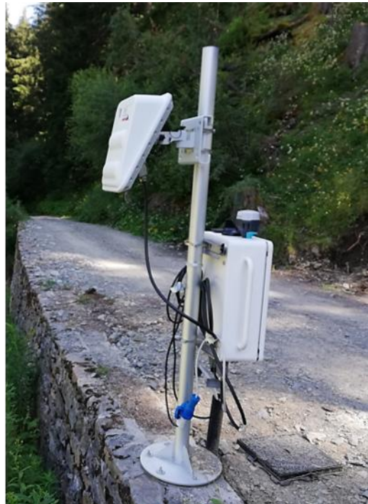
Figura A.18 – Esempi di sistemi radar doppler per l'allertamento in tempo reale di fenomeni di dissesto idrogeologico a cinematica rapida. Fonte: archivio UNIFI
