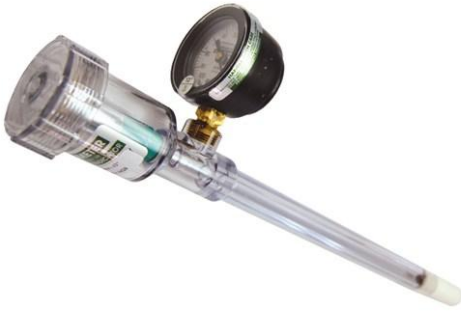
Figura A.44 - Tensiometro a tubo, dotato di vacuometro e capsula ceramica
