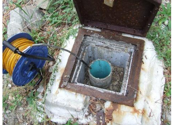
Figura A.42 - Sonda freatimetrica manuale per il rilievo della soggiacenza della falda. Fonte: archivio ARPAL
