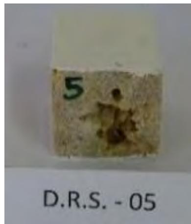
Figure 98. Spécimen avec des surfaces recouvertes d'une suspension de gypse, montrant aussi la porosité de la pierre de la *Rose des Sables*, (l'auteure, 2018).
