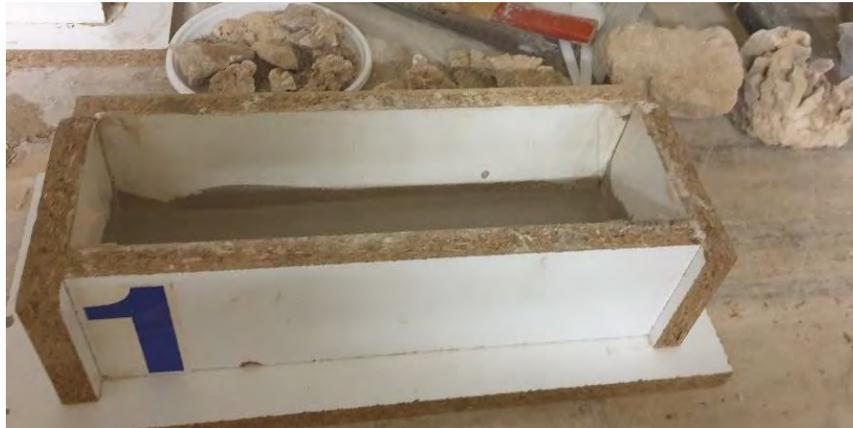
Figure 102. Bloc de coffrage de forme parallélépipédique, dimensions 34x10x10 cm<sup>3</sup>, (l'auteure, 2020).
