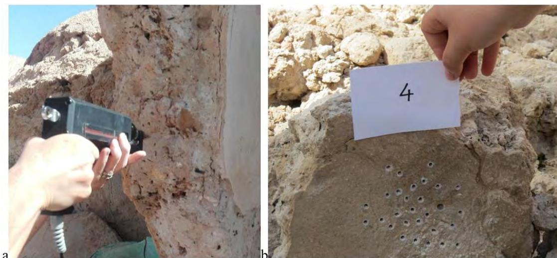
Figure 100. a & b. Tests par pénétromètre pour le mortier de gypse de la maçonnerie en Rose des Sables, (Cheima Azil et Luisa Rovero, 2019).
