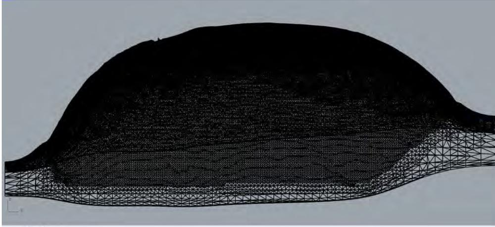
*Figure 66. Maillage d'une coupole relevée par scanner laser 3D, montrant l'irrégularité de la forme (l'auteure).*
