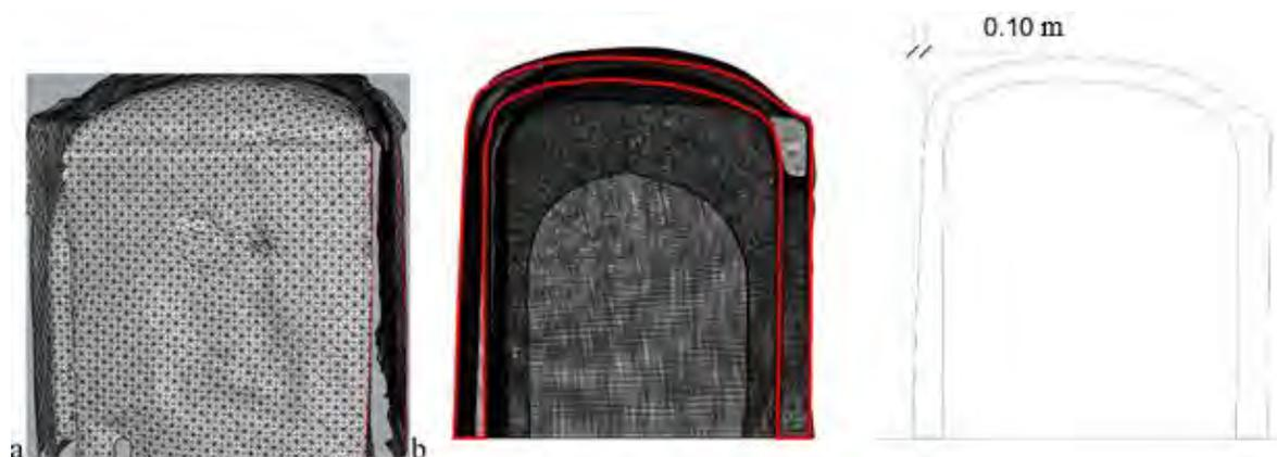
Figure 83. a. Maillage triangulé d'une cellule à coupole avec un mur déformé. b. Quantification de l'inclinaison d'un mur à partir d'une section au niveau du maillage triangulé d'une cellule à coupole (l'auteure).
