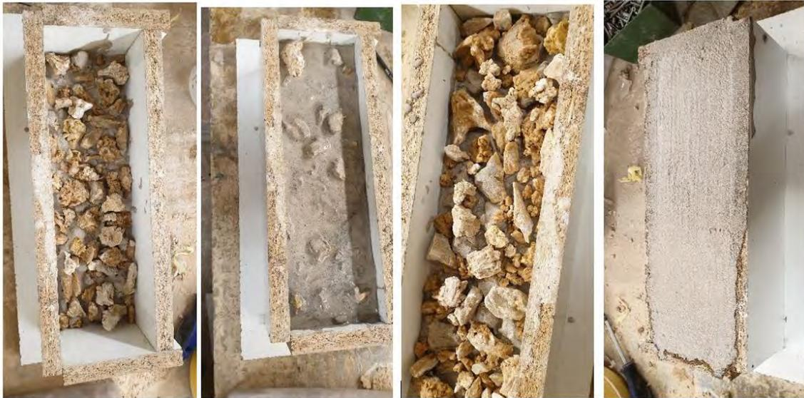
Figure 104. Étapes de préparation d'échantillon de maçonnerie en Rose des Sables M' à l'échelle 1: 5 dans le coffrage (l'auteure, 2020).
