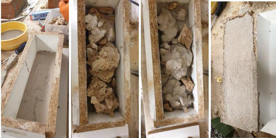
Figure 103. Étapes de préparation de l'échantillon M de la maçonnerie en *Rose des Sables* à l'échelle 1 : 2 dans le coffrage (l'auteure, 2020).
