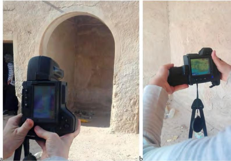
Figure 90. Utilisation de la caméra d'imagerie thermique pour mesurer la température des parois de la construction : a. à l'extérieur. b. à l'intérieur (l'auteur, 2019).
