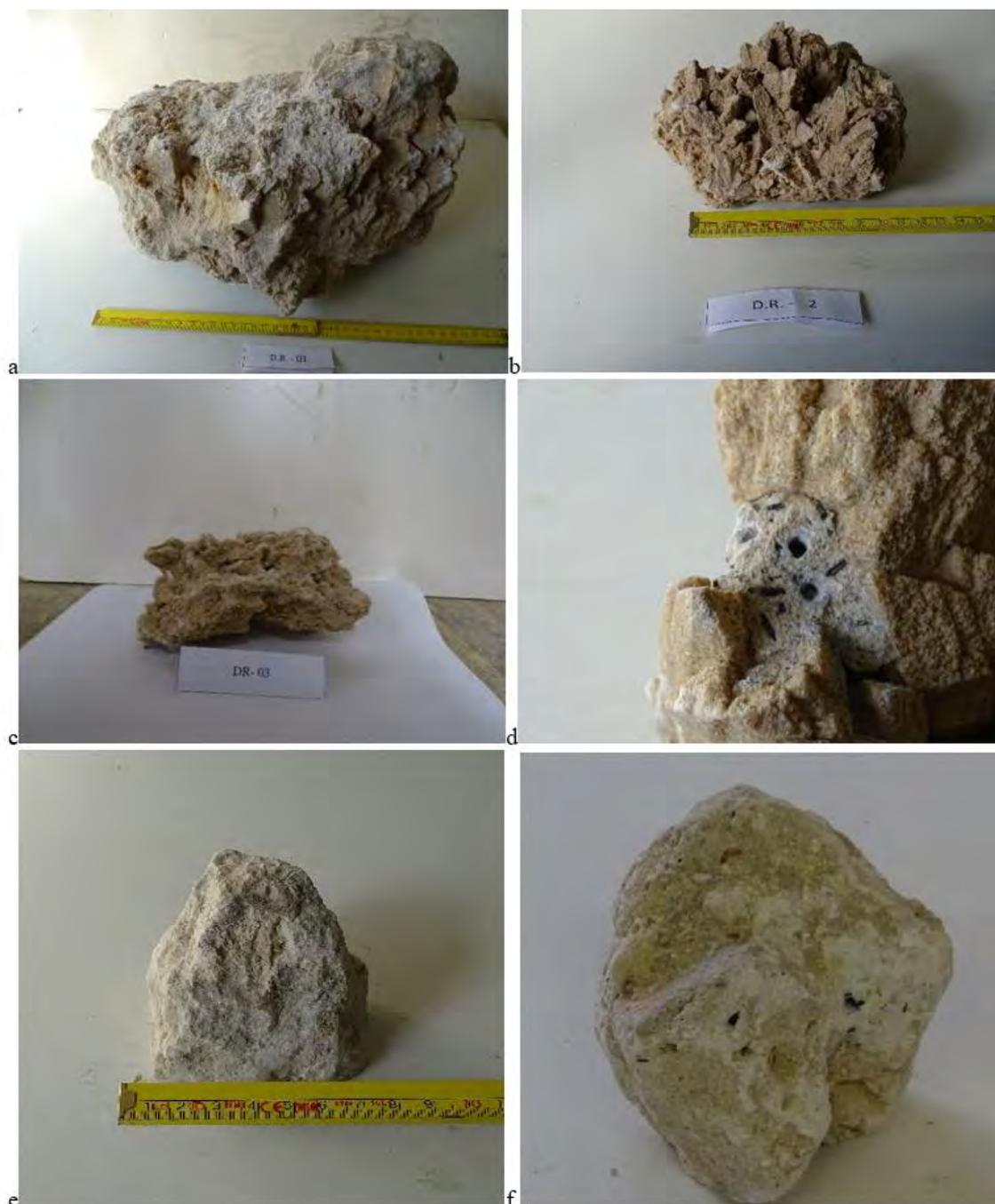
Figure 93. Échantillons constitués des pierres de la Rose des Sables sélectionnées et cataloguées comme suit : a. Échantillon DR1 ; b. Échantillon DR2 ; et c. Échantillon DR3. d. Échantillon de pierre de la Rose des Sables avec résidus de mortier prélevés sur des bâtiments endommagés. e. Échantillon TS, Tafza, la pierre utilisée pour produire le mortier. f. Échantillon MP, le mortier de jointement prélevé. (l'auteure, 2018).
