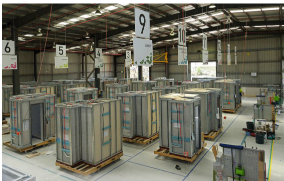
Fig.84 - Catena di produzione industriale di unità di servizio ( service pods ) non strutturali (Credits: Howick Ltd da www.howickltd.com )
