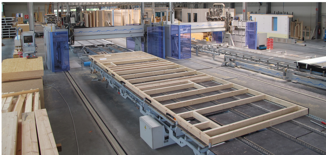
Fig.9 - La realizzazione off-site di parti e componenti di edifici adotta un approccio produttivo industrializzato. L'immagine mostra la catena di produzione di pannelli prefabbricati a telaio in legno (Credits: Homag; www.homag.com )
