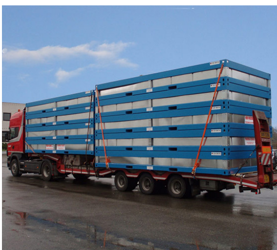
Fig.74 - Trasporto di unità in modalità in una configurazione flat-packed per l'ottimizzazione delle fasi di trasporto (Credits: Newhouse® da www.newhouse.it )
