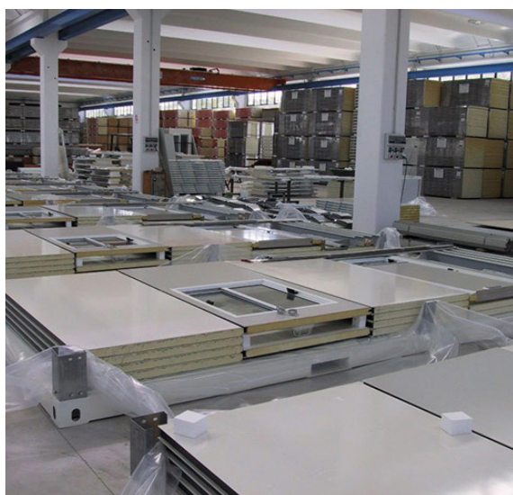
Fig.72 - Produzione industrializzata off-site dei componenti del sistema costruttivo secondo un approccio di standardizzazione (Credits: Newhouse® da www.newhouse.it)
