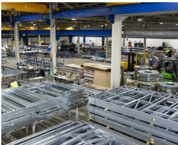
Fig.108 - Pannelli prefabbricati stoccati in officina per essere completati e trasportati in sito (Credits: LGSF Solutions in Steel da lgsf.co.uk)
