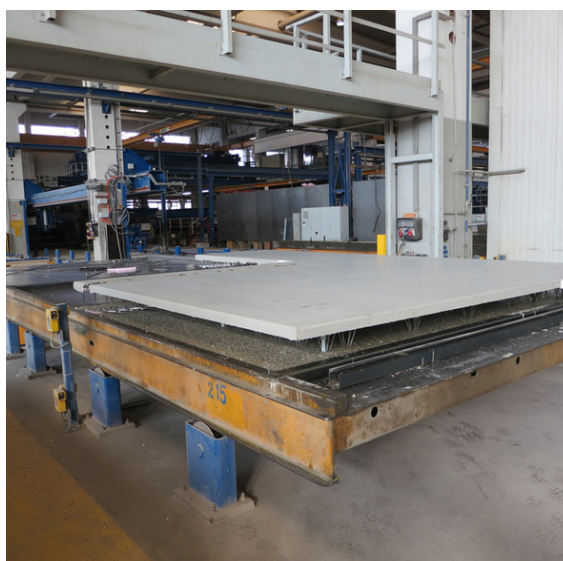
Fig.122 - Linea di produzione industrializzata dei componenti prefabbricati (Credits: Detail da https://www.detail.de/artikel/betonfertigteile-im-hochbau-8791/ )
