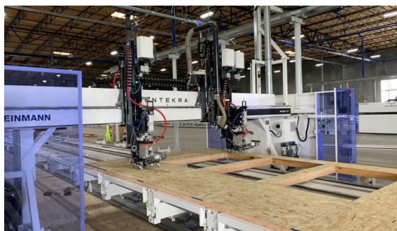
Fig.113 - Stazione della linea di assemblaggio e completamento dei pannelli (Credits: © Entekra Inc. da www.builderonline.com )
