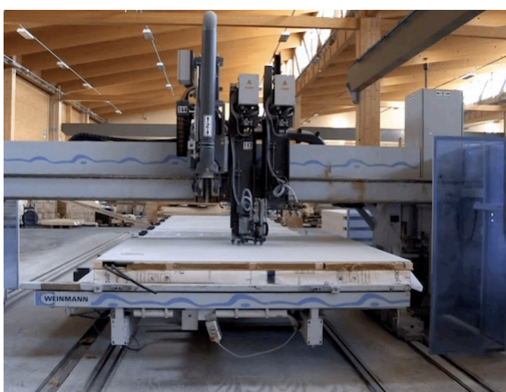
Fig.118 - Produzione industrializzata off-site dei pannelli (Credits: Novello Case da www.novellocaseinlegno.it )
