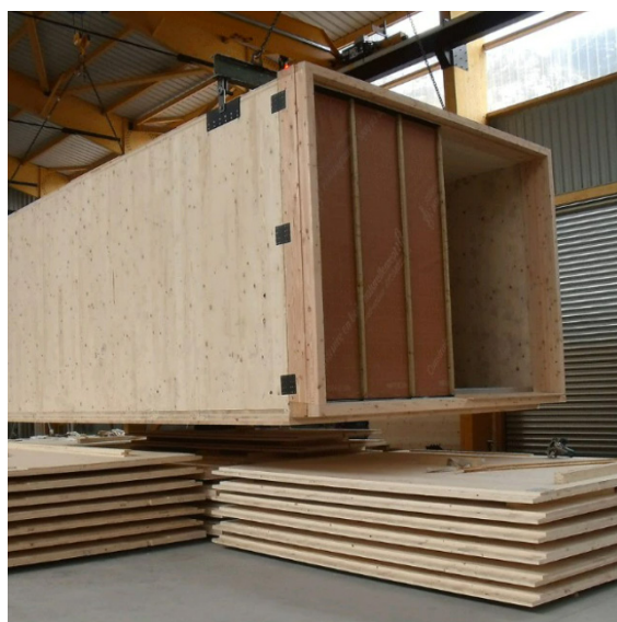
Fig.93 - Produzione off-site di unità modulari con struttura CLT per un complesso di social housing (PPA Architectures, 2016) (Credits: © Philippe Ruault da www.domusweb.it )
