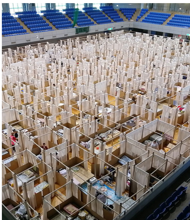
Fig.55 - Paper Partition System per l'emergenza post-sisma installato nel palazzetto dello sport di Hitoyoshi, nella prefettura di Kumamoto (Shigeru Ban Architects/VAN, 2020) (Credits: © Voluntary Architects Network da http://www.shigerubanarchitects.com/ )
