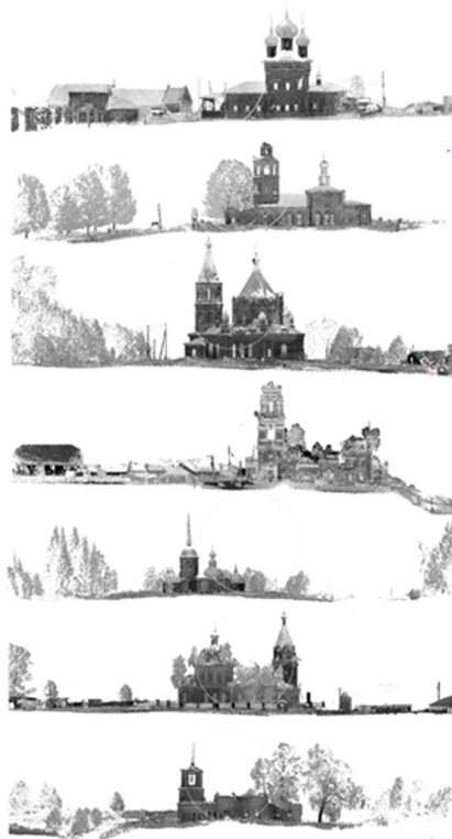
Fig. 4. Archivio digitale di dati spaziali morfometrici dei siti monumentali dell'Upper Kama: la molteplicità e l'estensione delle aree di rilievo dialogano con le finalità di rappresentazione dei livelli di OCH, influenzando dimensione e caratteristiche dei singoli database.
