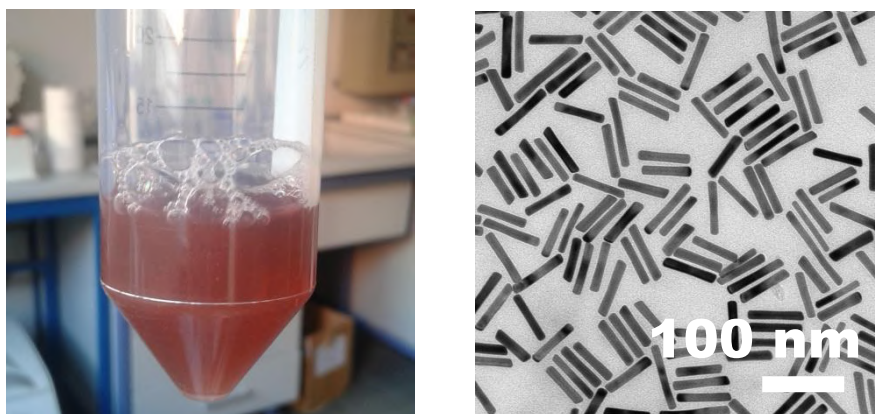
Figure 1.1: la figura a) a sinistra mostra una sospensione colloidale di nanorods d'oro; la figura b) a destra raffigura un'immagine TEM della relativa sospensione di rods.
