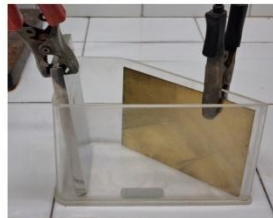
Fig. 2.4 a) Raddrizzatore di tensione, b) Cella di Hull (forma trapezoidale)
