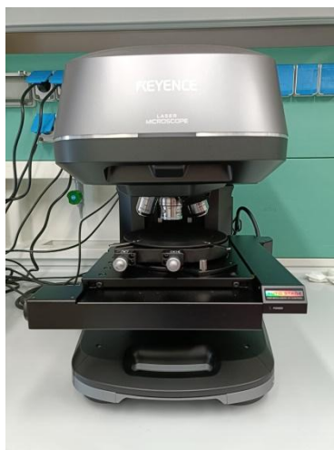
Fig. 2.11 Profilometro ottico confocale e interferometrico dotato di nove lenti (standard, APO, ELWD, SLWD e DI). Lo strumento è dotato inoltre di un accessorio per la misurazione degli spessori
