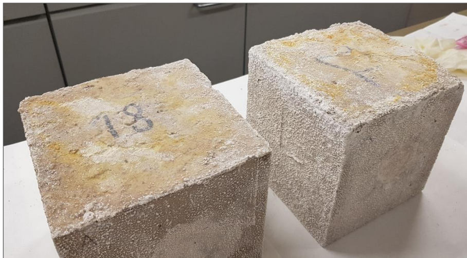
Figura 5.8. Deterioramento tipo delle superfici del provino dopo 40 giorni di immersione in soluzione acida di \text{H}_2\text{SO}_4 con pH 2.0÷2.5. In evidenza, il deposito superficiale di solfato di calcio e i segni di disgregazione in corrispondenza degli spigoli del campione.
