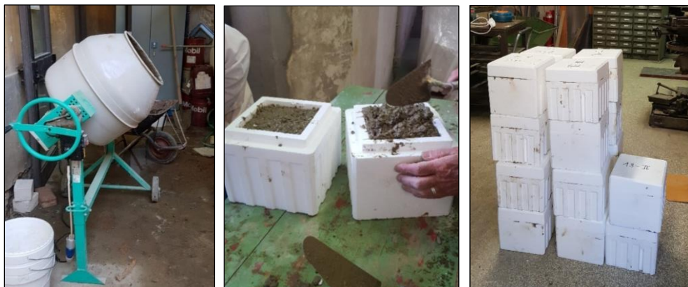
Figura 4.1. Fasi del confezionamento dei provini.
