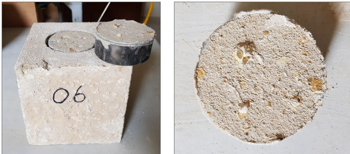
Figura 5.18. Esempio di rottura coesiva superficiale (effetto peeling ) tipica nel caso dei provini immersi in soluzione acida. Test di pull-off eseguito su provino invecchiato mediante 30 giorni di immersione in soluzione acida con pH 2 (provino 06 lato 1).
