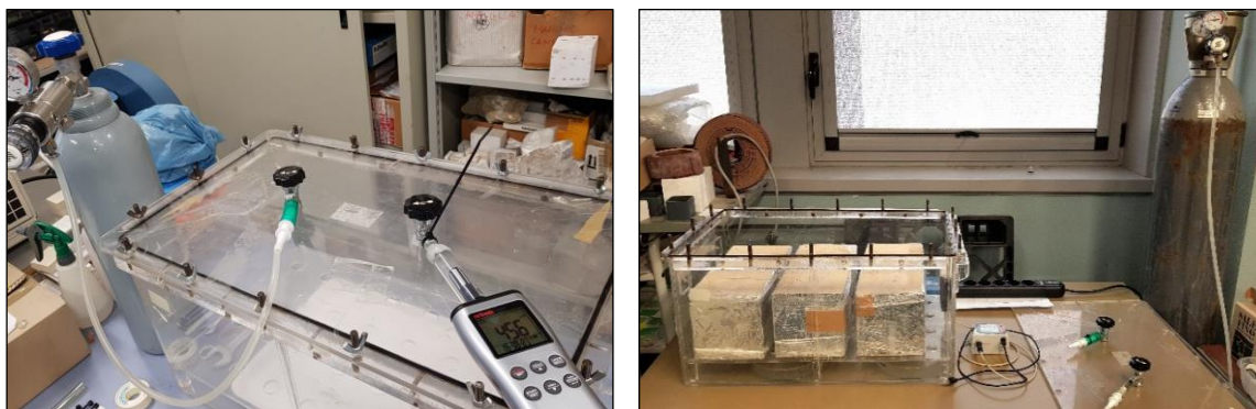
Figura 4.5. Sistema per l'iniezione e il monitoraggio della CO 2 nella camera di conservazione.
