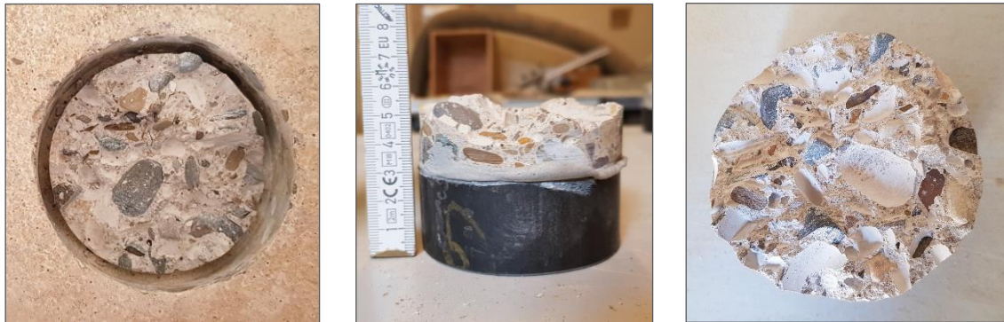
Figura 5.17. Esempio di rottura di tipo coesivo. Test di pull-off eseguito su provino invecchiato con 16 cicli di bagnato/asciutto in soluzione saturata di NaCl (provino 19II lato 1).
