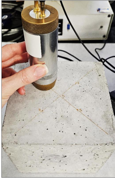
Figura 4.11. Schema delle misure dielettrometriche in campo evanescente eseguite su due facce contrapposte di ciascun provino.
