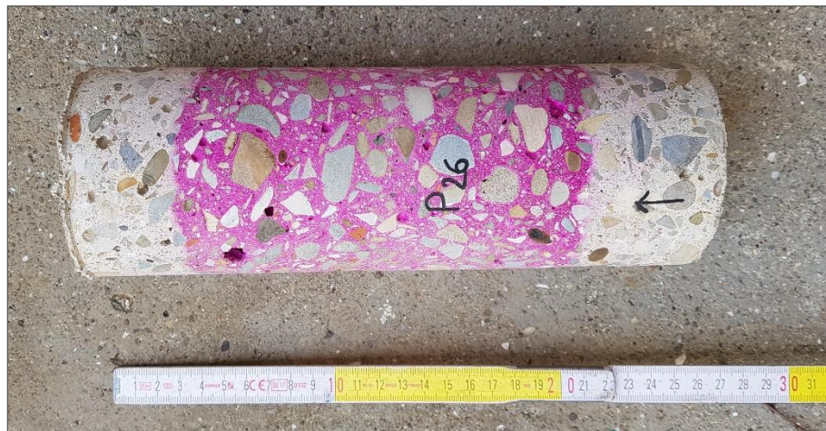
Figura 2.6. Determinazione della profondità di carbonatazione tramite metodo della fenolftaleina su una carota prelevata da un edificio con T_a = 44 anni. Le parti esterne carbonatate non mostrano alcuna alterazione di colore, mentre la parte interna non carbonatata ( \text{pH} > 9 ) è evidenziata dal viraggio al colore viola. La profondità di carbonatazione su entrambe le estremità della carota è di circa 4 cm (foto M. Castellini 2021).
