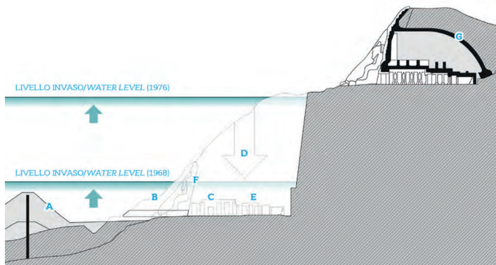
Sezione trasversale del sito di Abū Simbel e operazioni di ricollocamento / Cross-section of the Abū Simbel site and relocation operations (© Webuild Value. Rielaborazione / re-elaboration A²studio)
