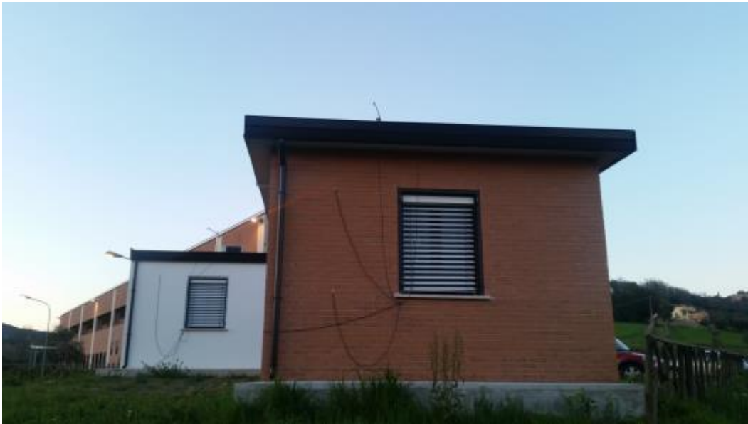
Figura 5-8 – Test Room impiegate per la campagna di sperimentazione in opera di schermature residenziali con controllo automatico
