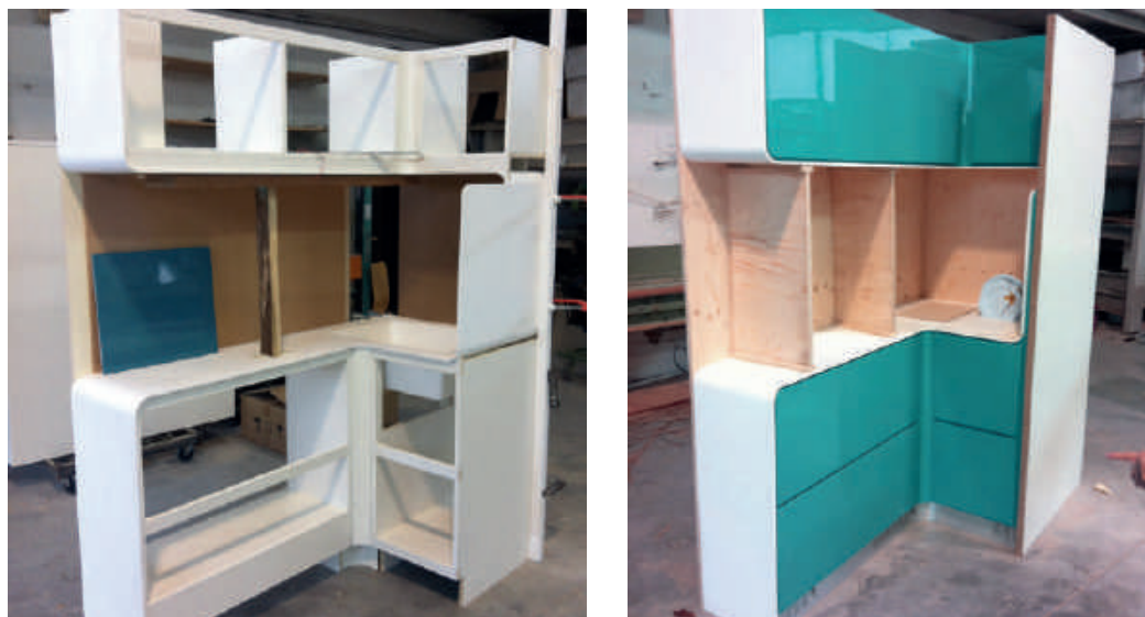
Fig. 12.15 | Prototipazione e sviluppo della struttura del sistema cucina.
